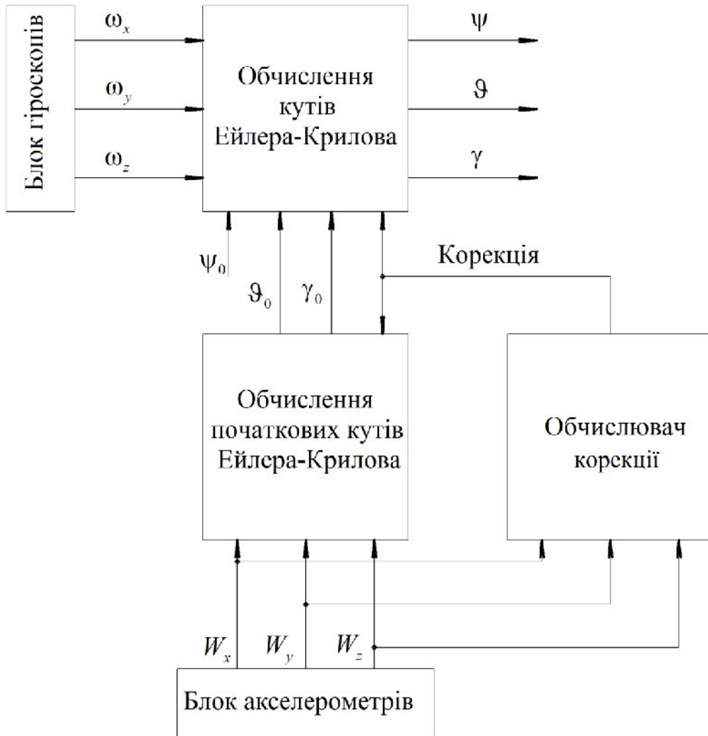
Рис. 1. Функціональна схема розробленої БСО
