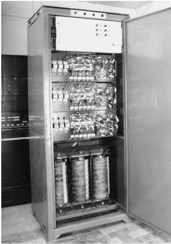
Рис. 3. АФСР для комплексного підвищення якості напруги в електричних мережах 0,4 кВ
