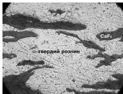
Рис. 2. Мікроструктура композиційного матеріалу складу: а — Cu + 10\% C (ДГр10); б — Cu - 5\% Ni - 9\% CaF_2 (ДН5КФ9), \times 500
