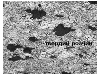
Рис. 2. Мікроструктура композиційного матеріалу складу: а — Cu + 10\% C (ДГр10); б — Cu - 5\% Ni - 9\% CaF_2 (ДН5КФ9), \times 500
