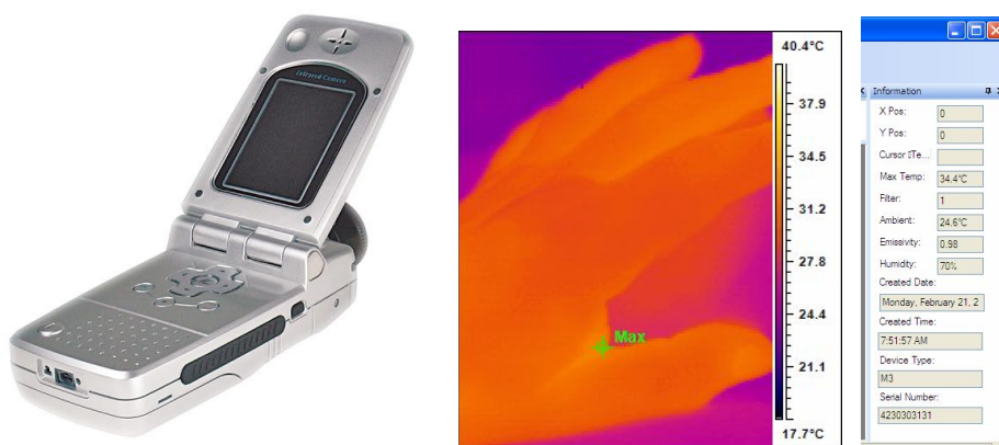
Рис. 3. Інфрачервона камера «MobiR M3», термограма індуктора та температурна інформаційна таблиця при контакті з біологічним об'єктом
