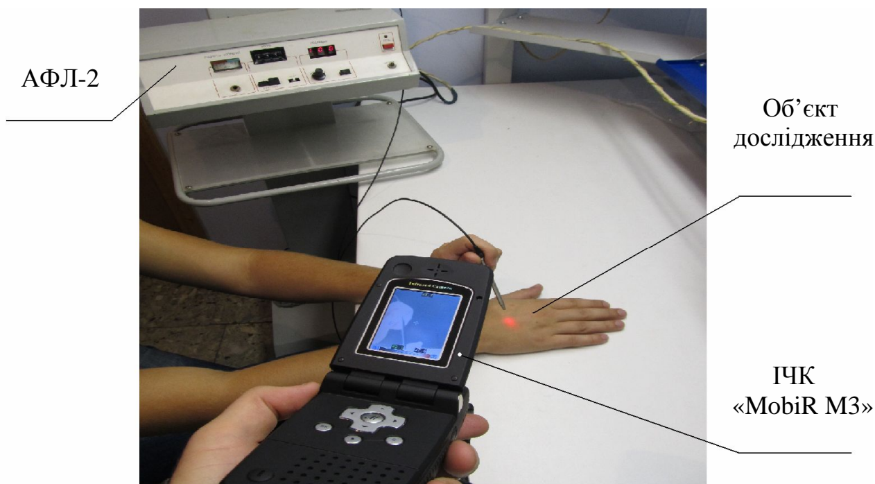
Рис. 2. Вимірювання температури ІЧК «MobiR M3» під час експерименту
