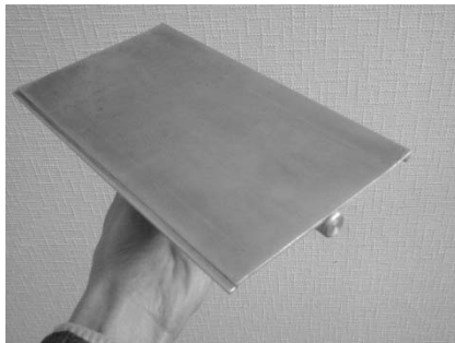
Рис. 1 Плавниковая конструкция тепловой трубы
