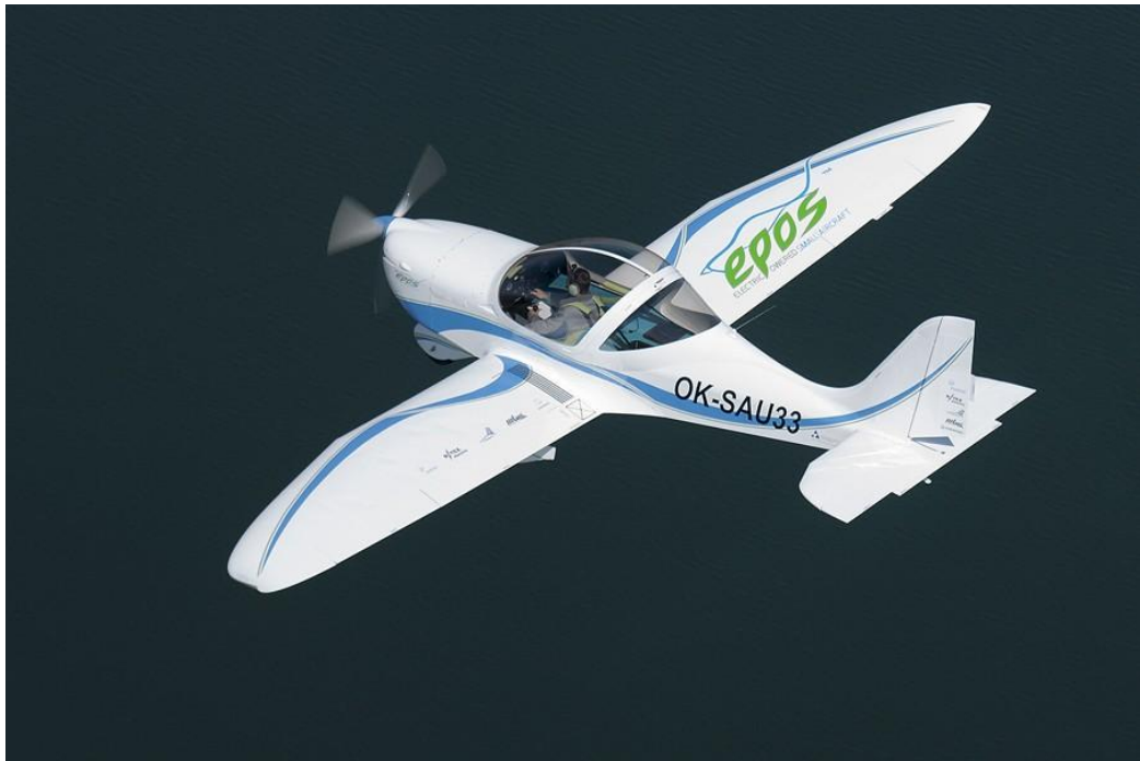
Obrázek 3: Evekter u svého letounu EPOS udává zhruba čtvrtinové náklady na „palivo“ oproti benzínové variantě s motorem Rotax
