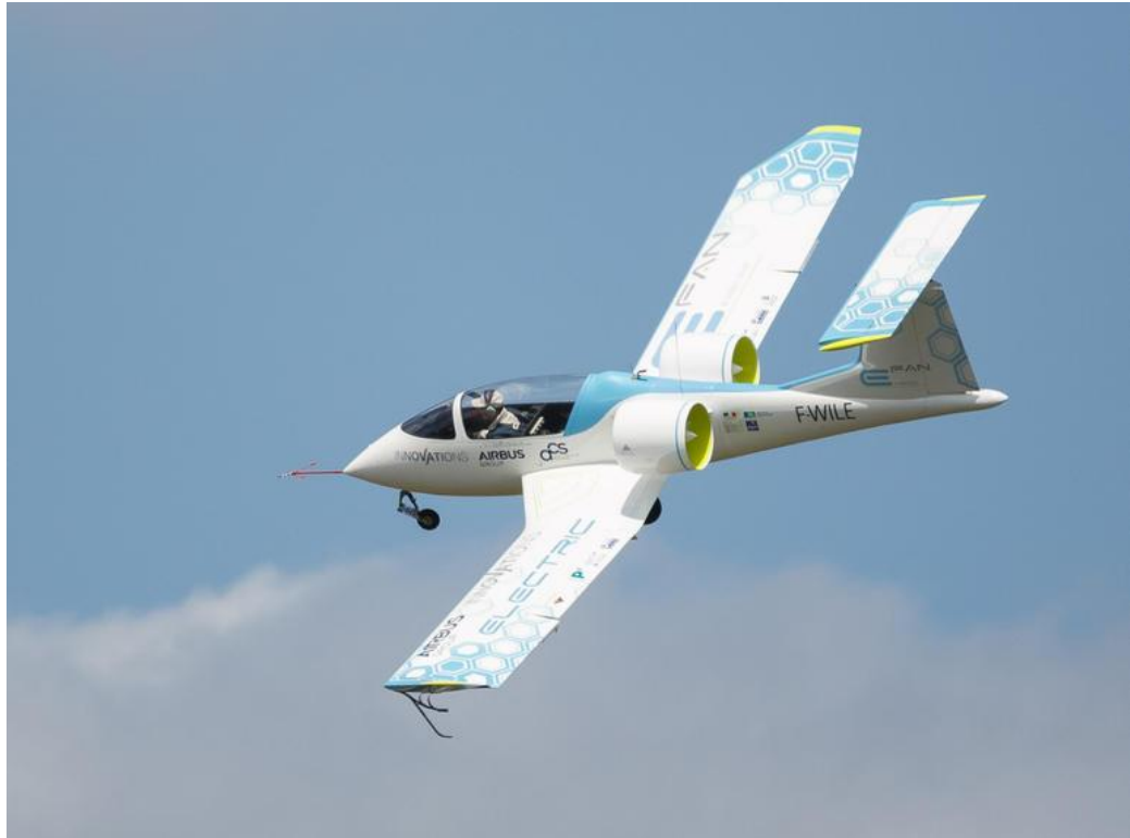
Obrázek 4: Elektrická „stíhačka“ E Fan společnosti Airbus slouží jako demonstrátor využití elektro dmychadel v letecké dopravě
