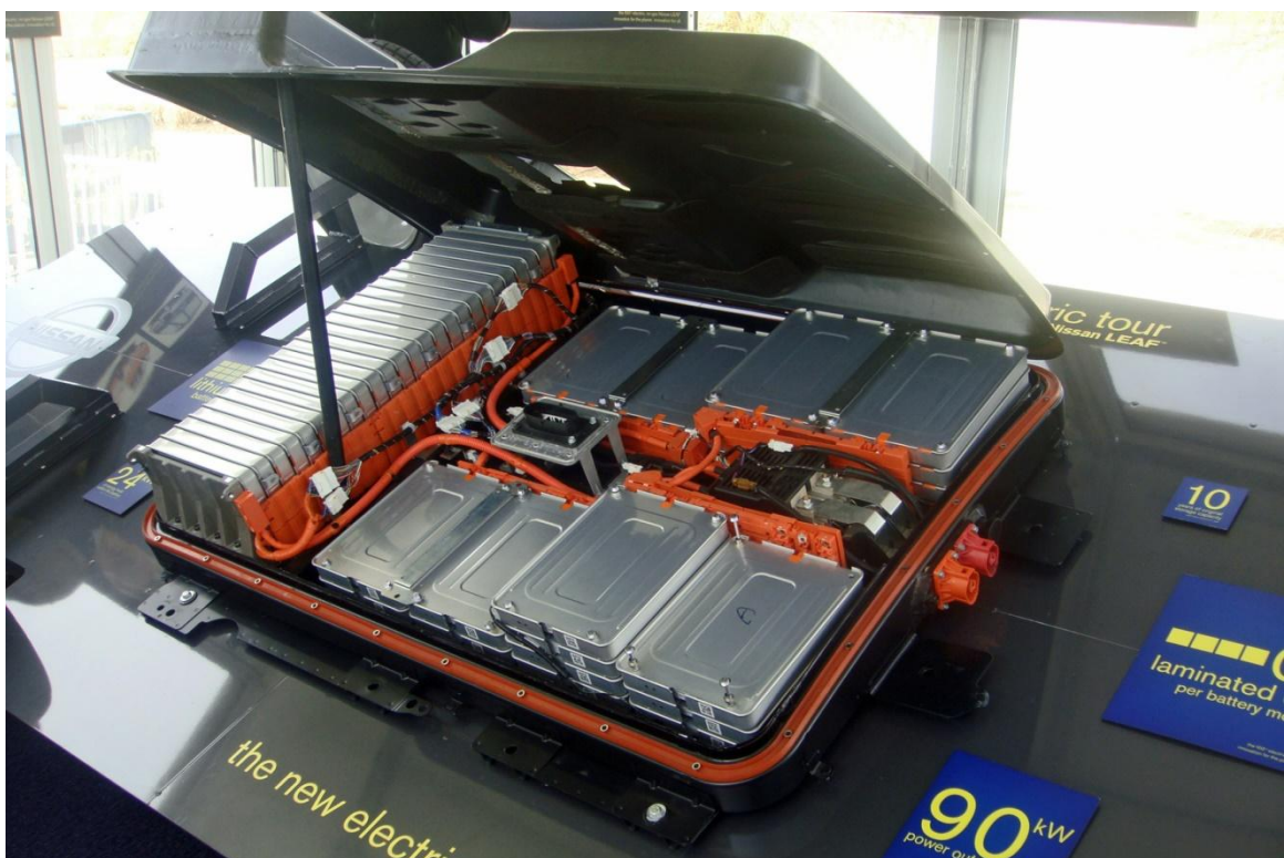
Obrázek 6: Lithiová baterie v otevřeném ochranném krytu je určena pro nejprodávavější elektromobil roku 2013 Nissan LEAF
