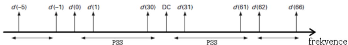
Obr. 12 – struktura PSS signálu ve frekvenční doméně
