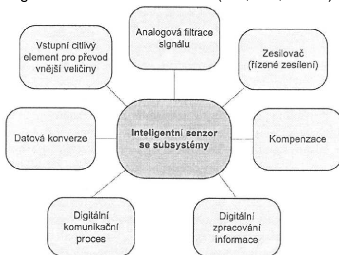
Obr. 4 - hlavní subsystémy tvořící inteligentní senzor [2]
