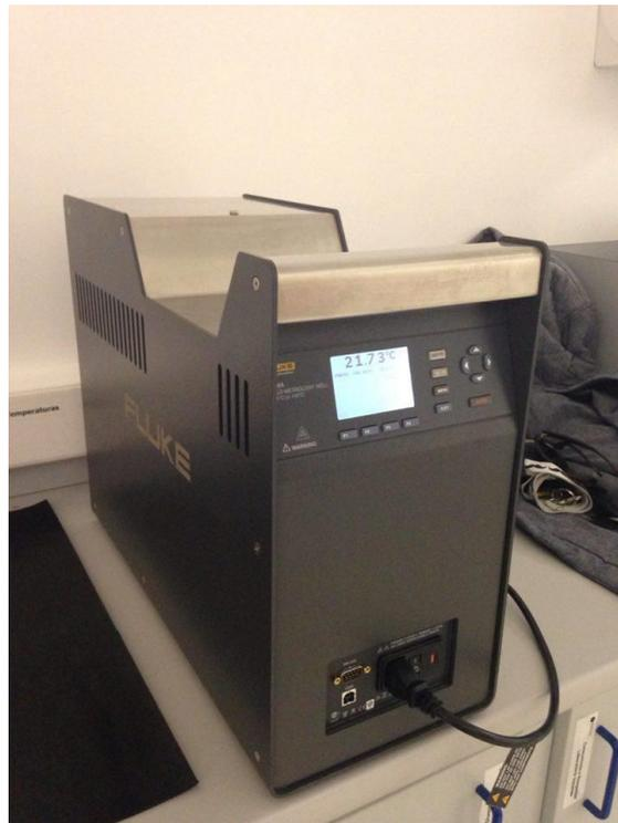
**Figura 53 Sensor padrão (em cima à esquerda), sensor padrão (em cima à direita) e banho seco (em baixo a meio) (cortesia Frilabo)**
