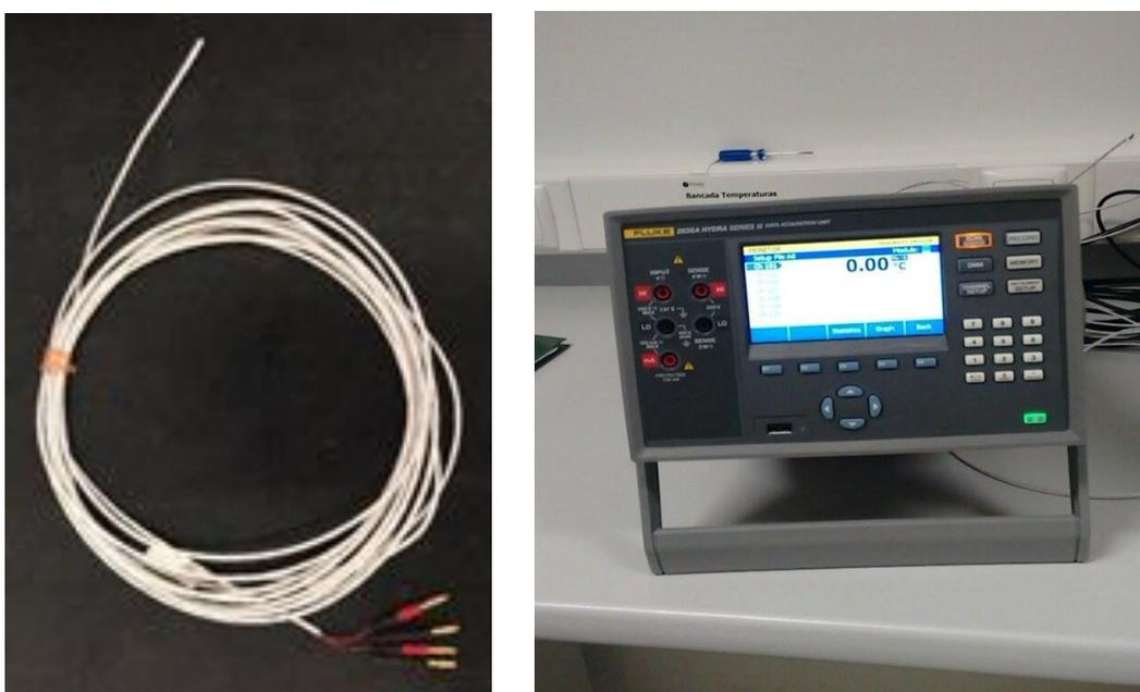
**Figura 28 Um dos 10 sensores Pt100 com ligação a 4 fios da Omega e multímetro da Fluke (cortesia Frilabo)**
