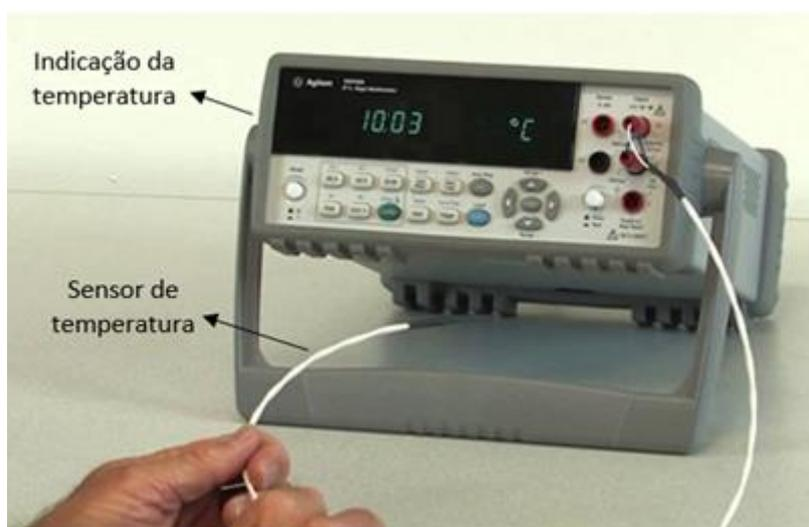
**Figura 2** Termómetro industrial (sensor e equipamento de leitura)
