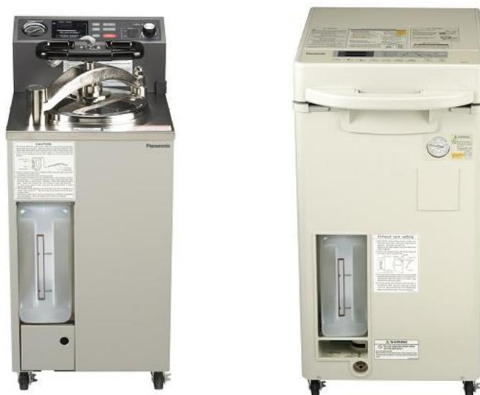
**Figura 23 Autoclave mais antiga, mas não desusada (à esquerda); autoclave mais recente com manípulo projetado para permitir a abertura e fecho da tampa com uma só mão (à direita) (cortesia Frilabo)**
