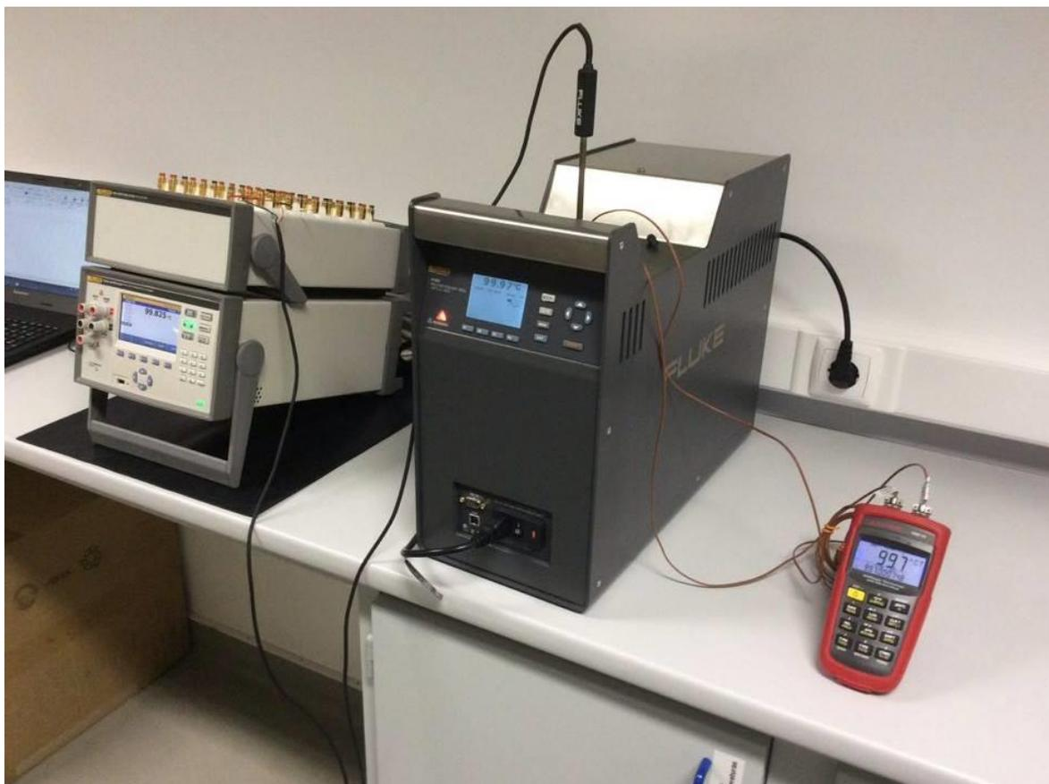
**Figura 56** Calibração de termómetros industriais – termómetro padrão (à esquerda), meio térmico (no meio) e termómetro em calibração (à direita) (cortesia Frilabo)
