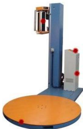
**Figura 15 - Máquina de colocação de filme**
