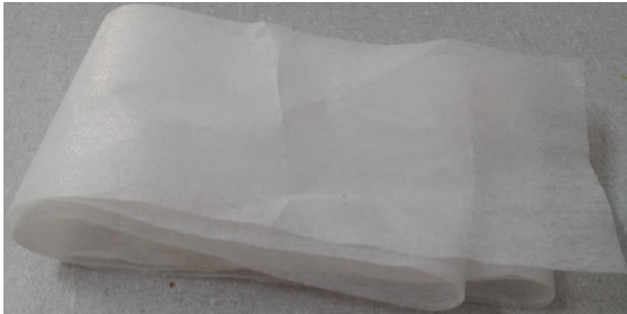
Figura 54 - Entretela utilizada para enrijecer o tecido
