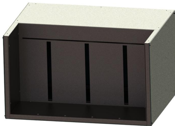
Figura 134 - Estrutura de empilhamento de peças fabricadas com blindagem colocada
