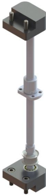
Figura 145 - Sistema de fuso acoplado nos mancais
