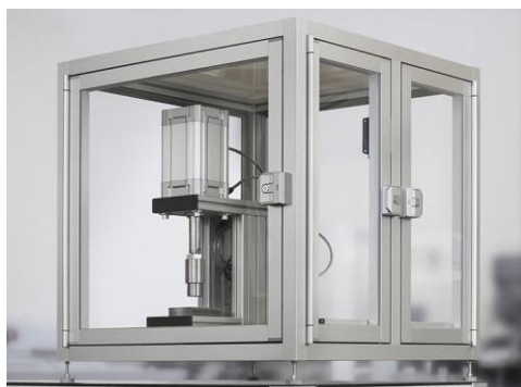
Figura 14 - Equipamento construído em perfil de alumínio
