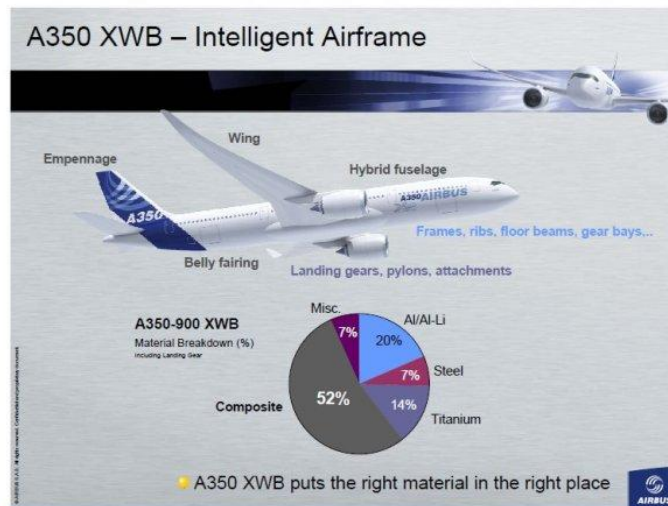
Figura 17 - Utilização de materiais compósitos no Airbus A350 [8]
