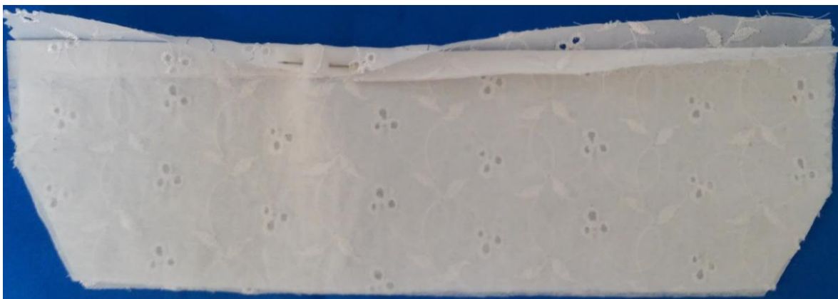
Figura 59 - Entretela colada no tecido com dobra já efetuada
