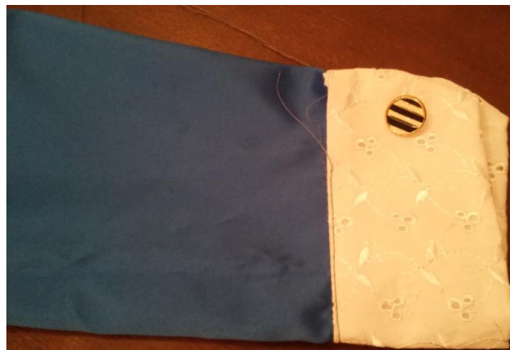
Figura 61 - Punho cozido numa manga de peça de vestuário
