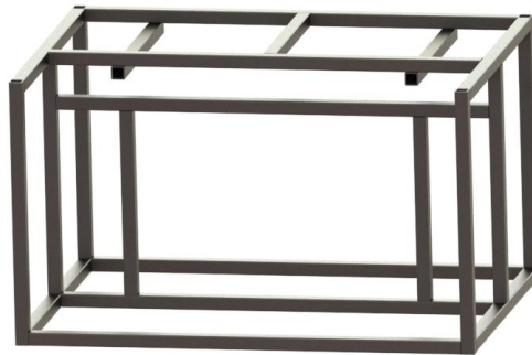
Figura 129 - Estrutura soldada em aço com tubo de secção quadrada (secção 20 x 20 x 2 mm 3 )
