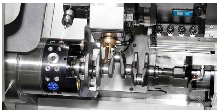
Figura 2: Exemplo de acabamento de uma cambota forjada (DANOBAT GROUP, 2014)
