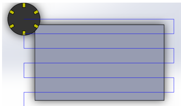
Figura 66: Exemplificação da trajectória seguida durante a operação de facejamento
