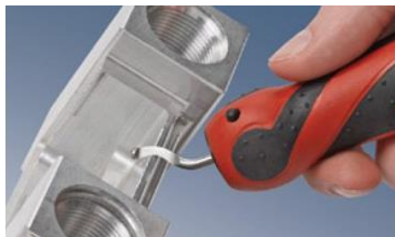
Figura 71: Exemplo de limpeza de arestas viva em peças maquinadas (VARGUS Ltd, 2010)
