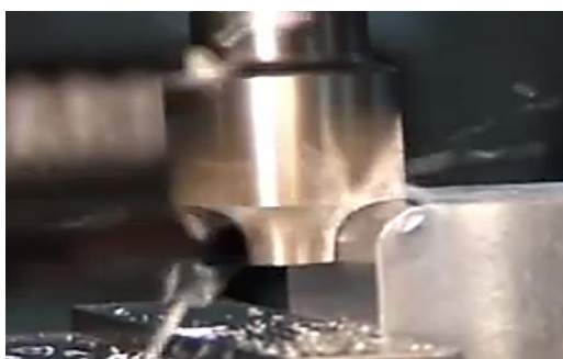
Figura 7: Demonstração da execução de um boleado por intermédio de uma fresa de canto (Techniques, 2013)
