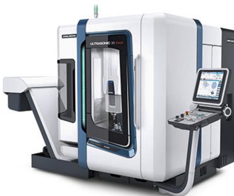
Figura 16: Exemplo de uma fresadora de cinco eixos DMG MORI SEIKI ULTRASONIC 30 linear (DMG MORI SEIKI, 2014)
