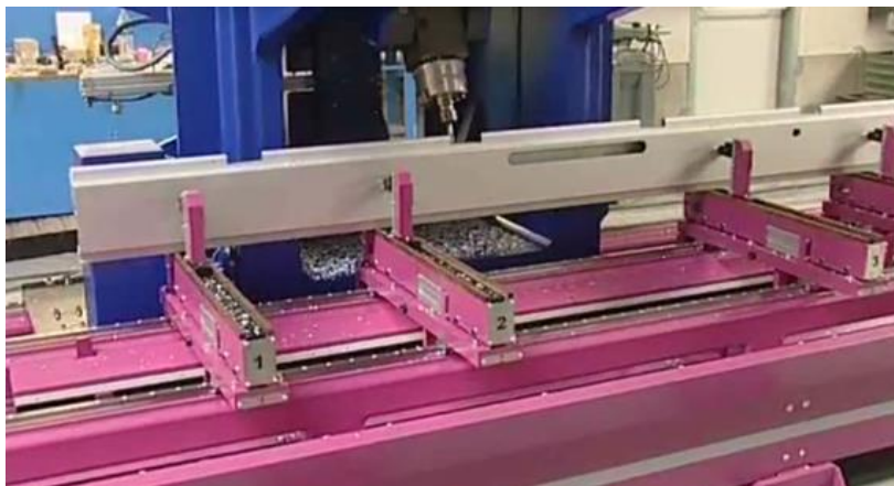
Figura 25: Exemplo de uma Furadora CNC a executar operações com a árvore inclinada (HACO Mubea Systems, 2013)
