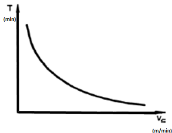
Figura 30: Gráfico da evolução do tempo de vida de ferramenta com o incremento da velocidade de corte (Tschätsch, 2007)
