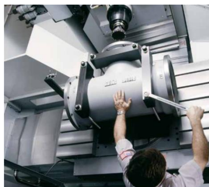
Figura 19: Exemplo de uma peça que necessita de maquinagem lateral (Haas Automation, Inc., 2013)
