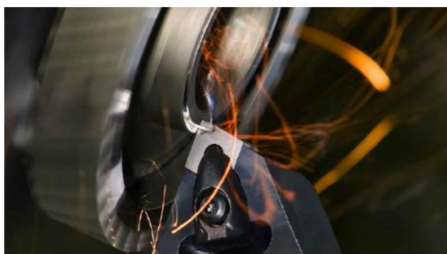
Figura 3: Demonstração do arranque de apara pelo método de torneamento (Sandvik Coromant, 2012)
