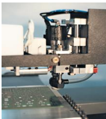
Figura 26: Aplicação de uma furadora CNC para gravação de placas de circuitos eléctricos (DIGIMAC)
