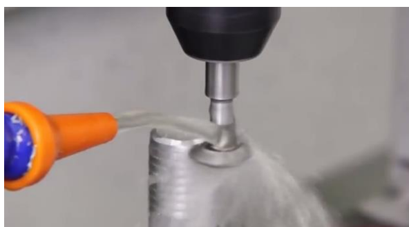
Figura 10: Operação de roscagem externa por interpolação (Tormach CNC, 2010)
