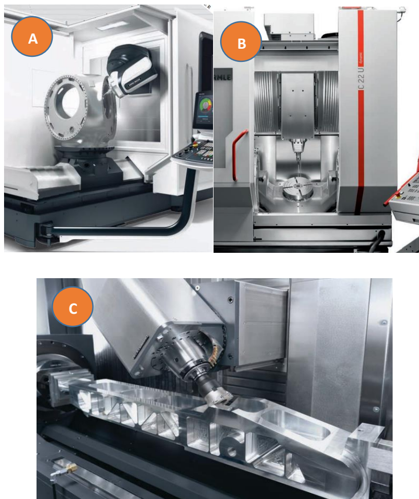
Figura 23: Diferentes tipos de fresadoras CNC de cinco eixos (rotação da árvore e rotação da mesa) (DMG MORI SEIKI, 2014) (Hermle Maschinenbau GmbH, 2014) (DMG MORI SEIKI, 2014)
