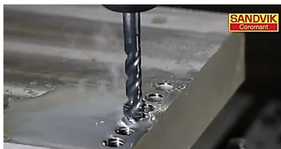
Figura 8: Demonstração da operação de roscagem por intermédio de um macho (Sandvik Coromant, 2012)
