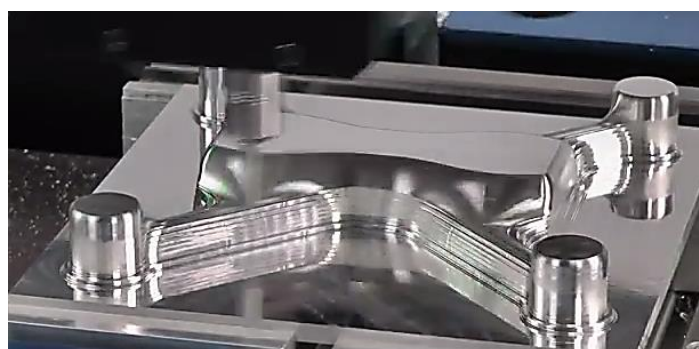
Figura 11: Exemplo de uma peça obtida por maquinagem a três eixos contínuos (Dantron CNC, 2013)
