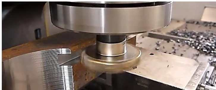
Figura 13: Execução de um canal lateral por intermédio de uma fresa “T” (Seco Tools, 2012)
