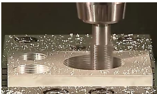
Figura 9: Operação de roscagem interna por interpolação (Guhring, Inc., 2012)
