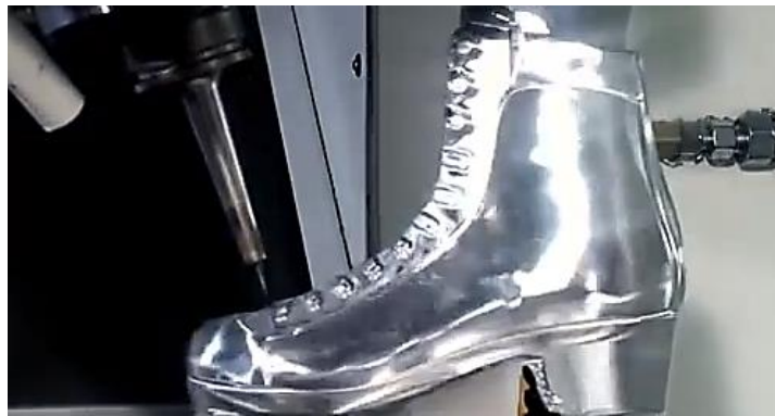
Figura 12: Exemplo de uma peça obtida por maquinagem a cinco eixos contínuos (DMG MORI SEIKI Media, 2012)
