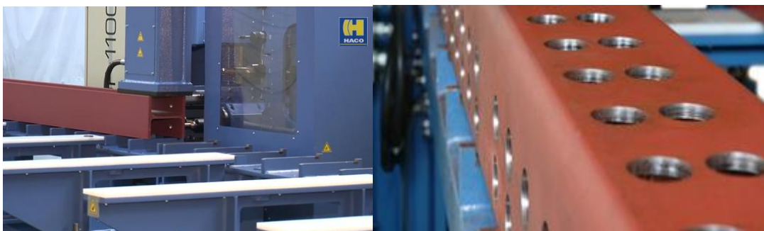
Figura 24: Exemplo de uma Furadora CNC a operar numa viga estrutural (HACO, 2011)
