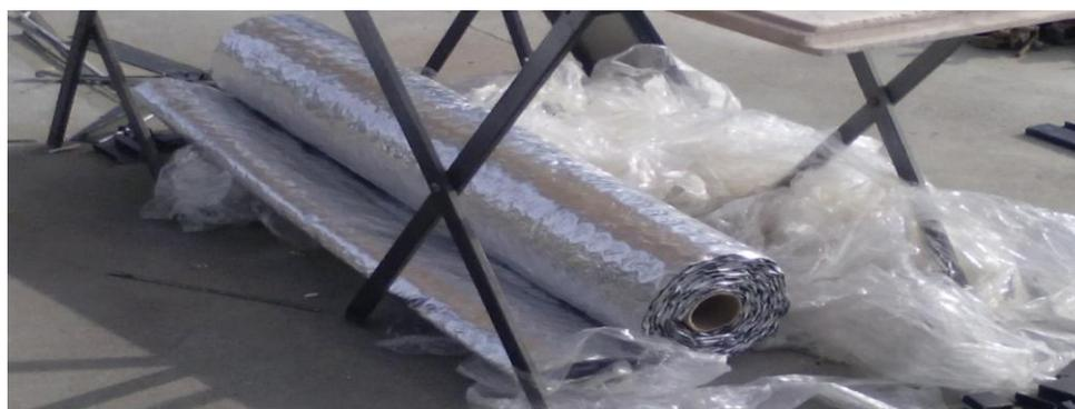
Fig. 61-Isolamento térmico alternativo BOLTHERM (foto do autor)
