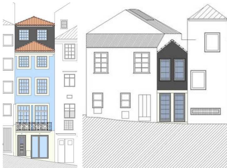
Figura 18 - Fachada principal e tardoza após a reabilitação do edifício (Fonte: Porto Vivo, SRU)
