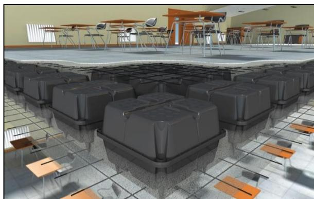
Figura 2.4 – Solução de aligeiramento - Sistema U-Boot [5]
