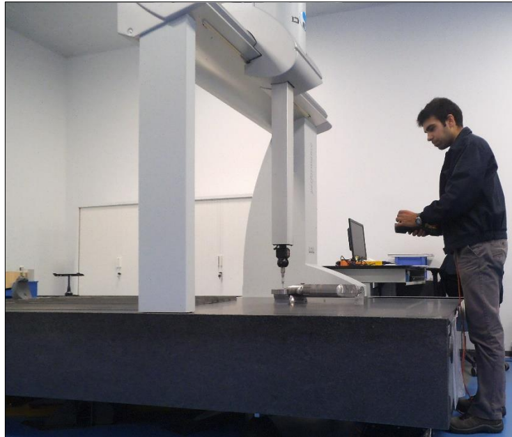
Figura 51 – Medição de uma peça em titânio com recurso à MMC.
