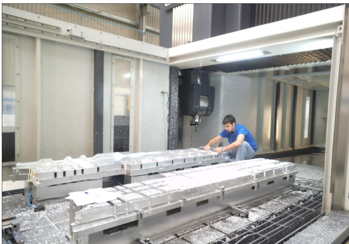
Figura 34 – Validação do diâmetro e posicionamento de furos na máquina ferramenta CNC.
