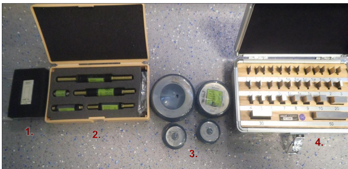
Figura 11 – Padrões de Trabalho, laboratório de Metrologia, CAER. 1. Padrão de trabalho do rugosímetro; 2. Padrão de trabalho do micrómetro de interiores; 3. Anéis para micrómetros de interiores; 4. Caixa de blocos padrão de diferentes dimensões.
