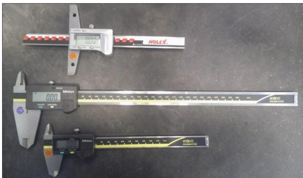
Figura 35 – Paquímetros digitais no Laboratório de Metrologia da CAER; (a) – Paquímetro de profundidades de 150 mm; (b) – Paquímetro de 300 mm; (c) – Paquímetro de 150 mm.
