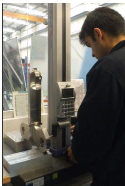
Figura 40 – Medição do componente aeronáutico de titânio no graminho.
