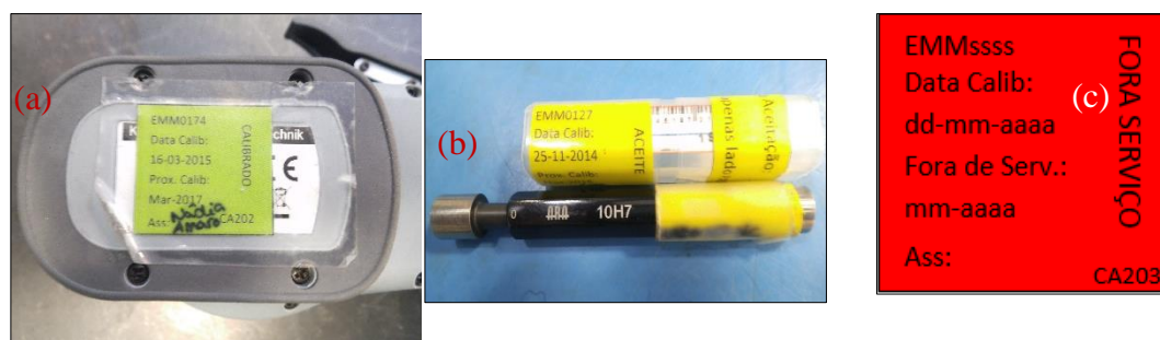
Figura 33 – Etiquetas com as diferentes cores; (a) – Equipamento Calibrado; (b) – Equipamento Aceite sob Concessão; (c) – Equipamento Fora de Serviço.
