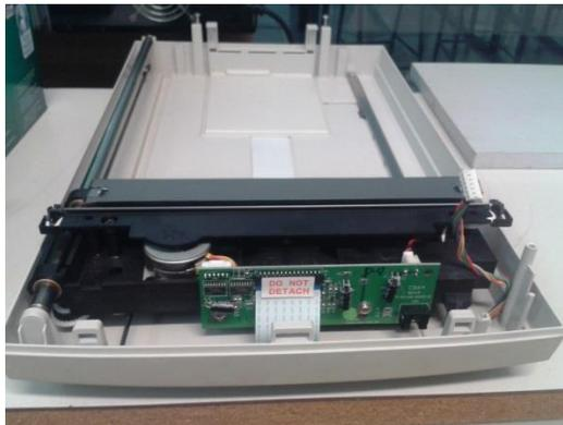
Figura 4.5 – *Scanner* reconvertido utilizado enquanto guia horizontal
