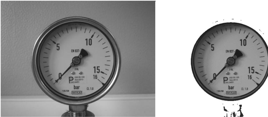
Figura 2.3 - Suavização através de um filtro de mediana da imagem transformada em tons de cinzento (à esquerda), seguida do procedimento de crescimento de região (à direita)
