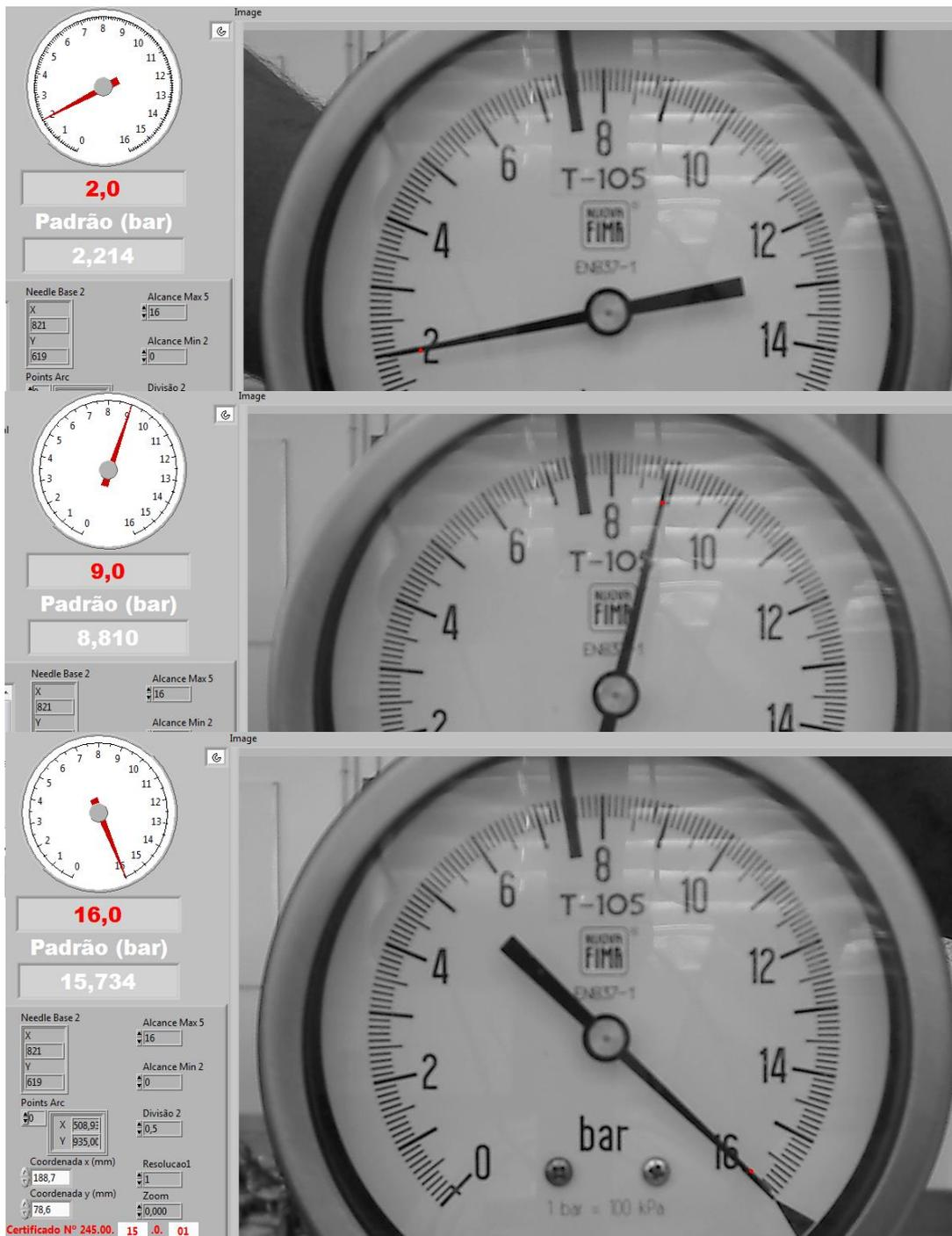
Figura 5.2 – Sequência de imagens retiradas sensivelmente no início, meio e fim de escala
