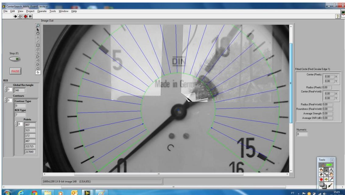
Figura 5.1 – Imagem resultante da distorção introduzida pela lente
