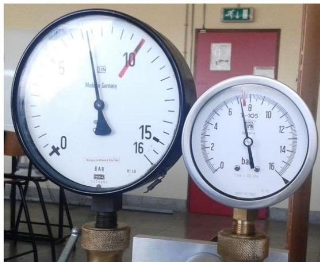
Figura 4.3 – Manómetro de 100 mm e 80 mm de diâmetro, respetivamente
