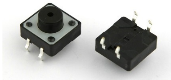
Fig. 4.3: Representação de um push button
