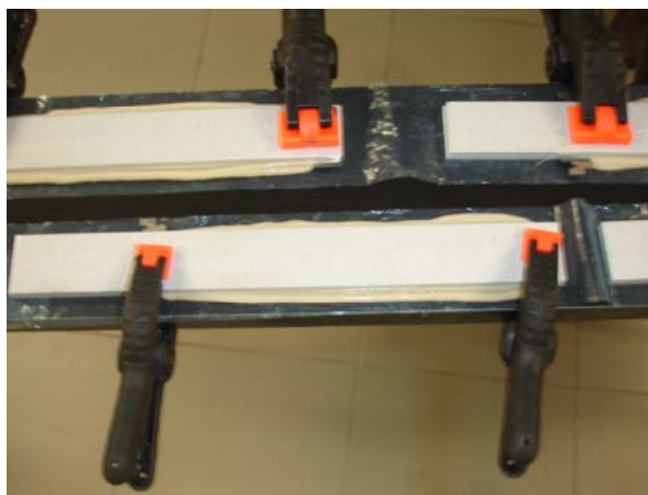
Figura 62 - Processo de posicionamento durante a cura.
