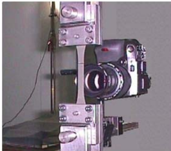
Figura 15 - Medição da deformação com base num sistema de registo fotográfico (da Silva et al. 2006).
