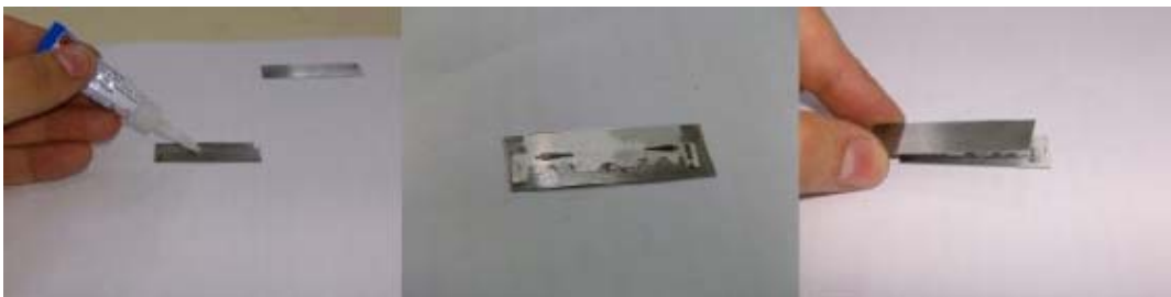
Figura 60 - Fabrico do calço frontal (lâmina).
