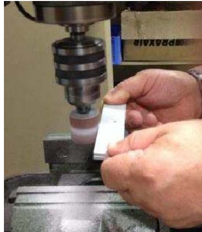
Figura 63 - Limpeza dos bordos dos provetes.
