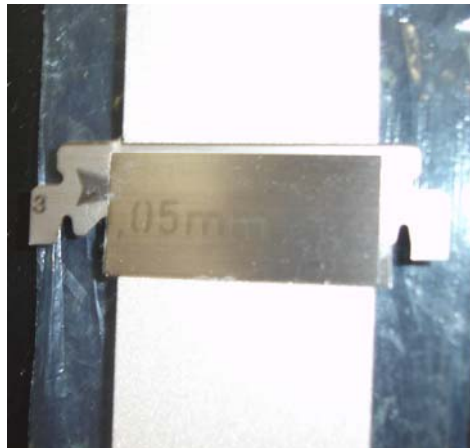
Figura 59 - Calço frontal na posição da pré-fenda.
