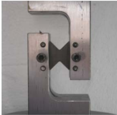
Figura 17 - Provete e respetivas fixações para o ensaio Arcan.
