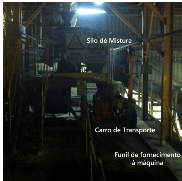
Figura 34 – Plataforma de transporte de areia para as máquinas de sopragem
