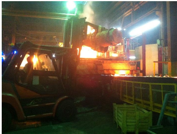
Figura 38 – Transferência de ferro do colherão de transporte para a banheira da MK5
