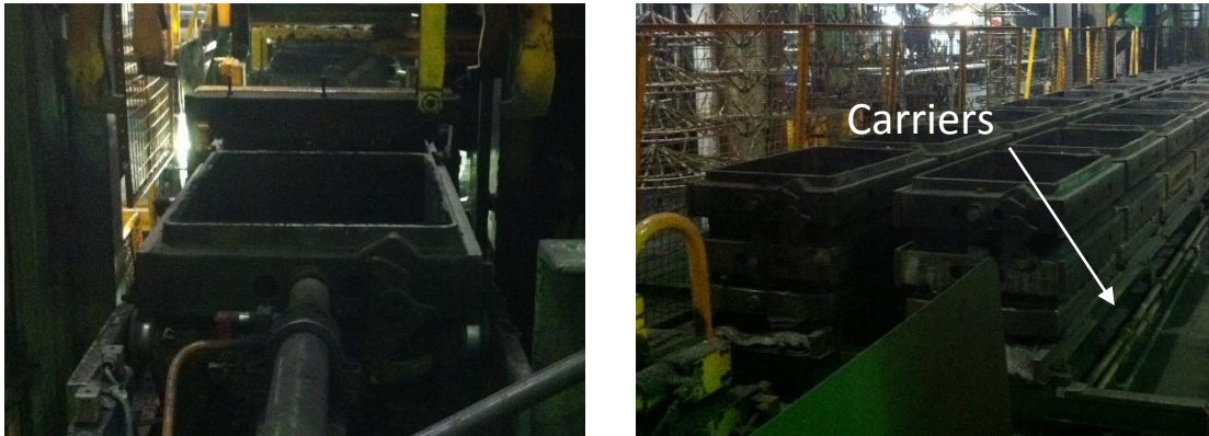
Figura 45 e 46 – Frames e carriers da máquina de moldar GF
