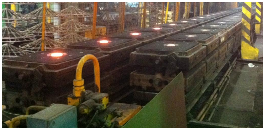
Figura 48 – Linha de arrefecimento GF
