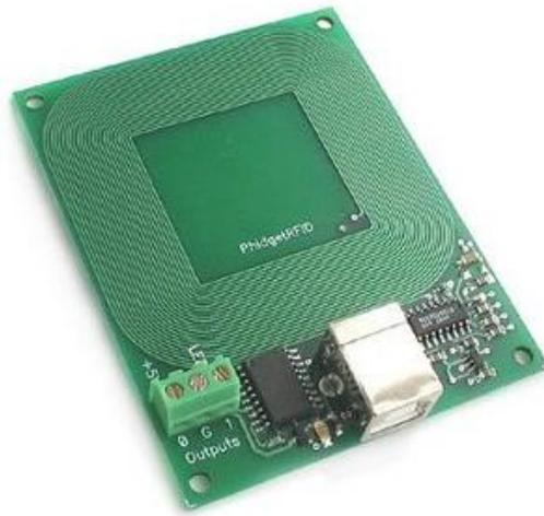
Figura 13 - Phidget reader utilizado neste projecto
