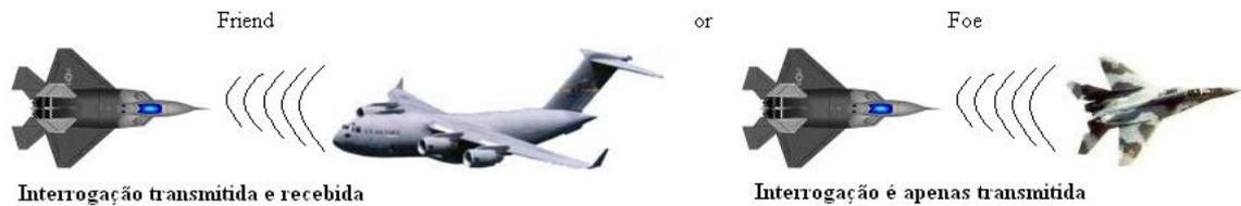
Figura 5 - Ilustração do funcionamento do sistema IFF
