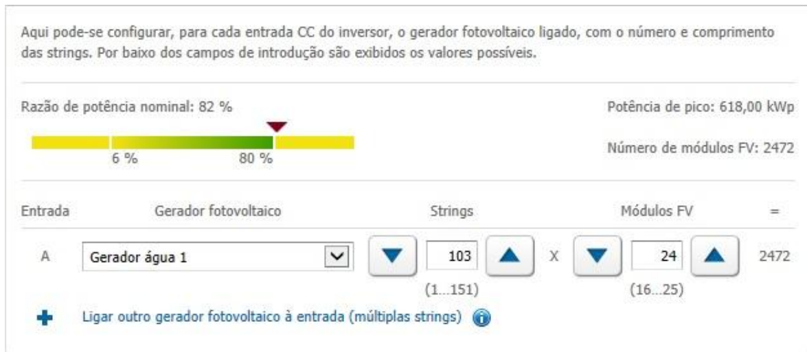
Figura 30 Configuração de fileiras para o Sistema 3 (por inversor) [20]
