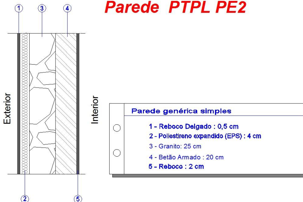
Figura 69 - Ponte térmica plana PE2 (cedida pela empresa)
