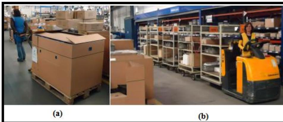
Figura 12 – Abastecimento (a) manual e (b) por comboio.
