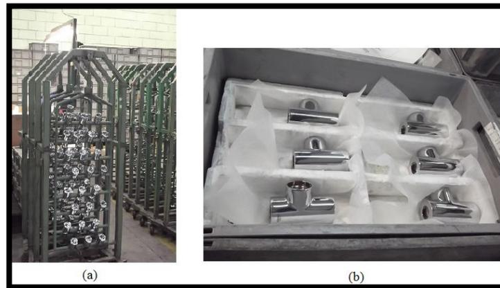
Figura 11 – Corpos abastecidos por (a) suspensões e em (b) caixas de esferovite.
