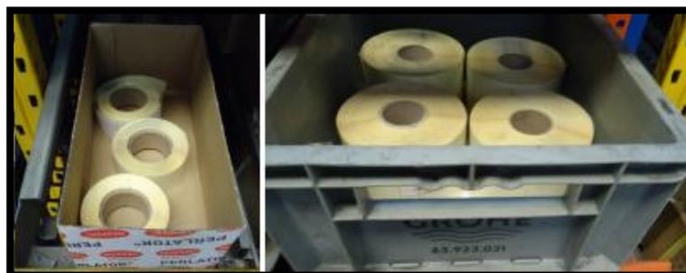
Figura 71 – A arrumação em caixas diminui a degradação dos componentes.
