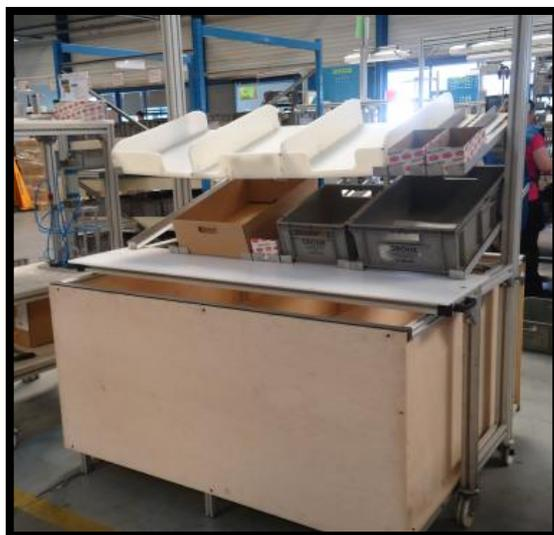
Figura 114 – Bancada e estrutura para colocação das mangueiras.
