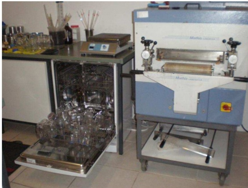
Figura 4.2: Laboratório Têxtil da Colorstar – de cima para baixo e da esquerda para a direita, vista da placa de aquecimento elétrica onde se efetuam os ensaboamentos e fervuras, da máquina de lavar loiça de laboratório e da râmula (máquina para fazer tratamentos por termofixação em acabamentos).
