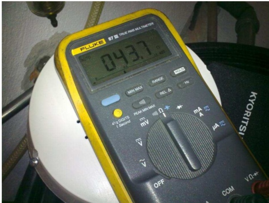
Figura 7.4: Momento da medição onde se regista a leitura de 43,7 ohm.
