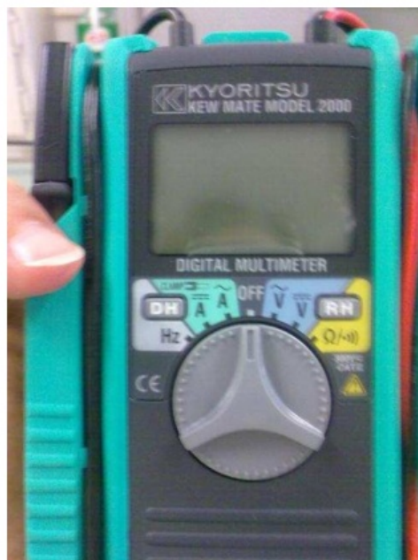
Figura 7.1 e 7.2: Multímetros marca Fluke 87 III Kyoritsu kew mate Model 2000 respetivamente, utilizados nas medições.
