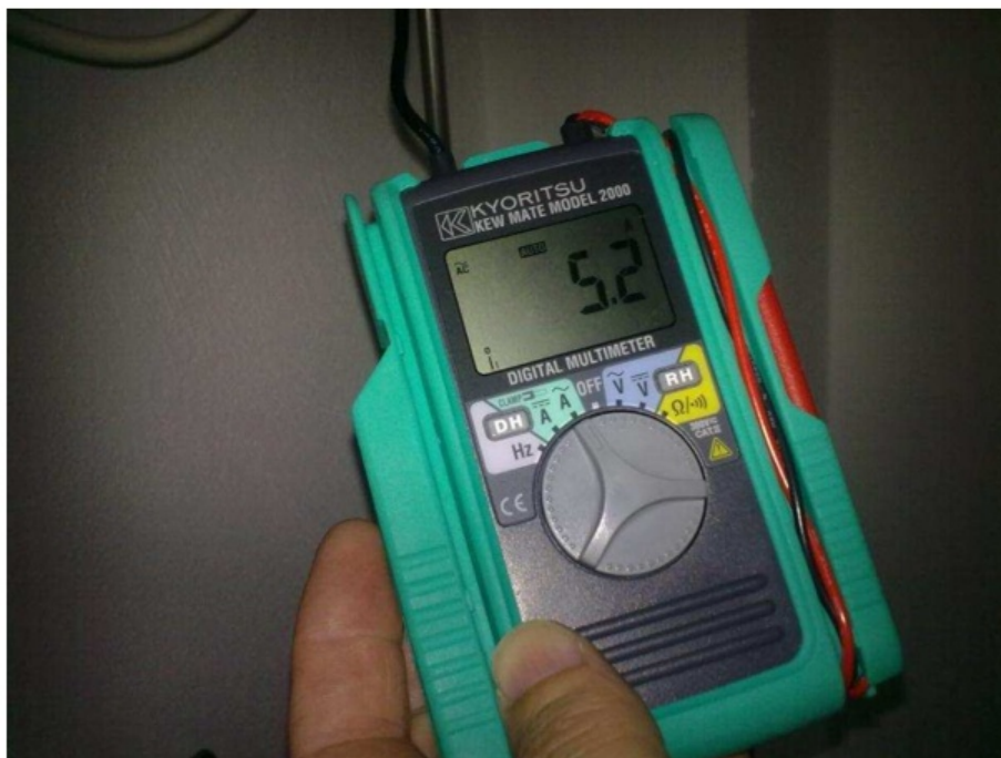
Figura 7.5: Momento da medição onde se regista a leitura da intensidade da corrente de 5,2 A.
