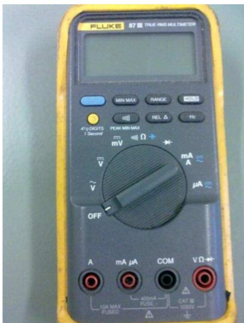
Figura 7.1 e 7.2: Multímetros marca Fluke 87 III Kyoritsu kew mate Model 2000 respetivamente, utilizados nas medições.
