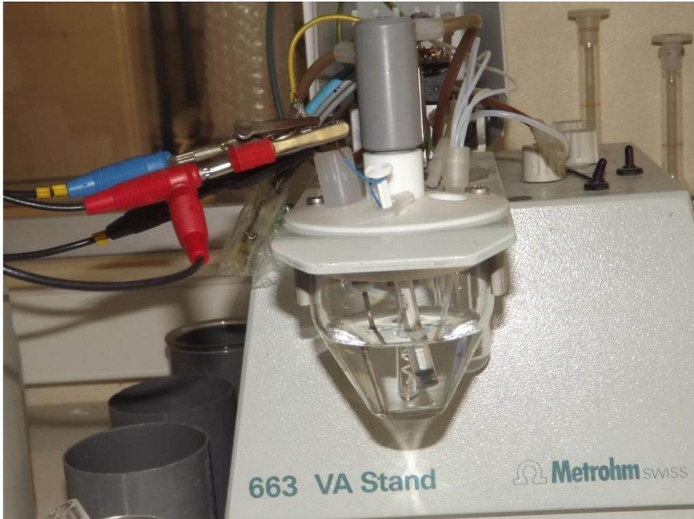
Figura 2.8 – Fotografia da célula eletroquímica
