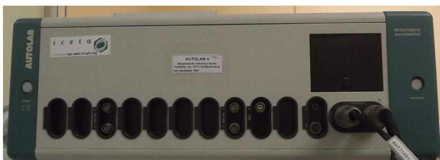
**Figura 2.1** - Fotografia do equipamento Autolab Metrohm, modelo PGSTAT 12.
