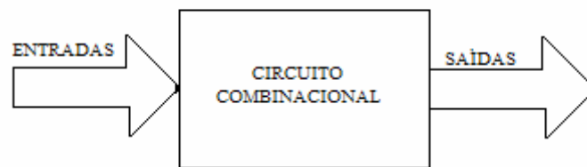
Figura 23 – Esquema geral de um circuito lógico combinatório
