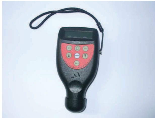
Figura 3.3. - Medidor de espessuras (Coating Thickness Gauge VF DC 8639).
