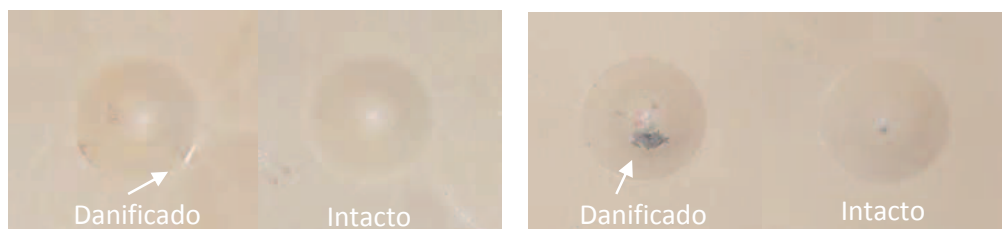
Figura 4.4. - Exemplos de classificação da resistência ao choque (frontal à direita e no verso à esquerda)
