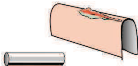
Figura 2.21. - Exemplo de rutura de uma película no teste de flexibilidade [24].
