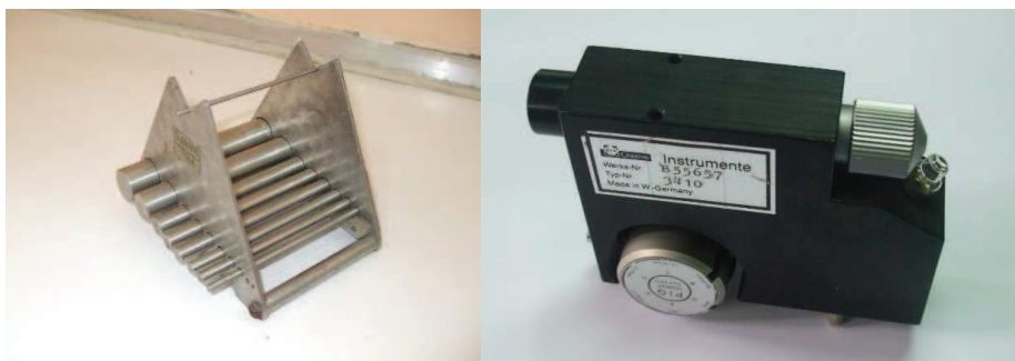
Figura 3.5. - Mandril cilíndrico – Ch. Braive (esquerda); Aparelho para medir a dureza – Byk Type n.º3410 (direita).
