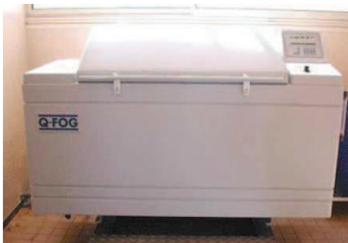
Figura 2.25. - Exemplo de uma câmara de nevoeiro salino [31].
