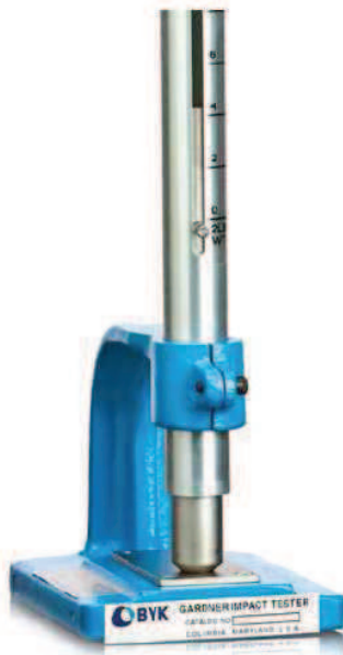
Figura 2.23. - Aparelho para medir a resistência ao impacto [24].
