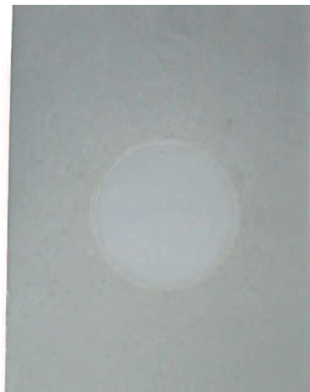
Figura 4.23. - Área exposta do primário de zinco, após 24 h de exposição á solução de NaCl (3,5% massa).
