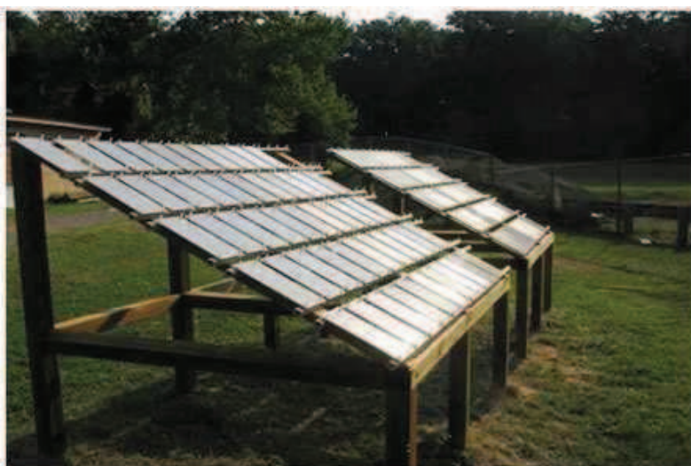
Figura 2.26. - Exemplo de teste de exposição ao ar livre [32]
