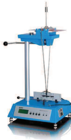
Figura 2.18. - Equipamento para medição da dureza pendular [24].
