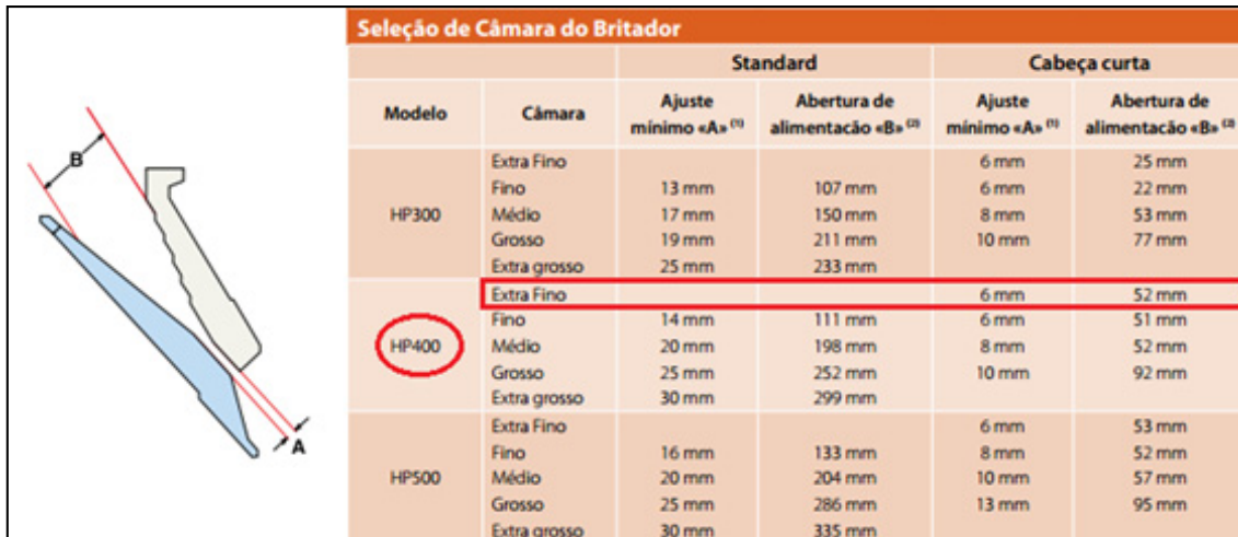
Figura 39 - Características da câmara do britador selecionado ( http://www.metso.com , 2014).
