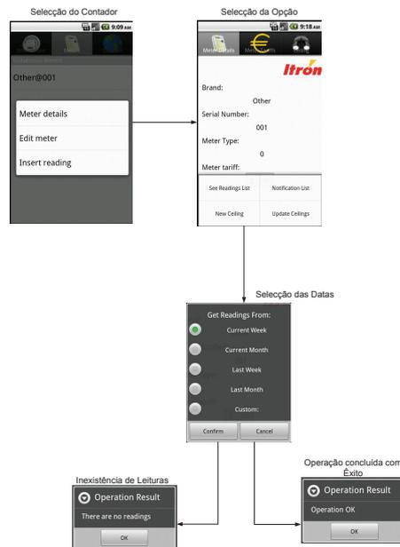
Figura 4.22: Sequência de obtenção de leituras.
