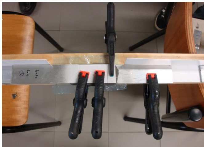
Figura 20 – Processo de montagem das juntas
