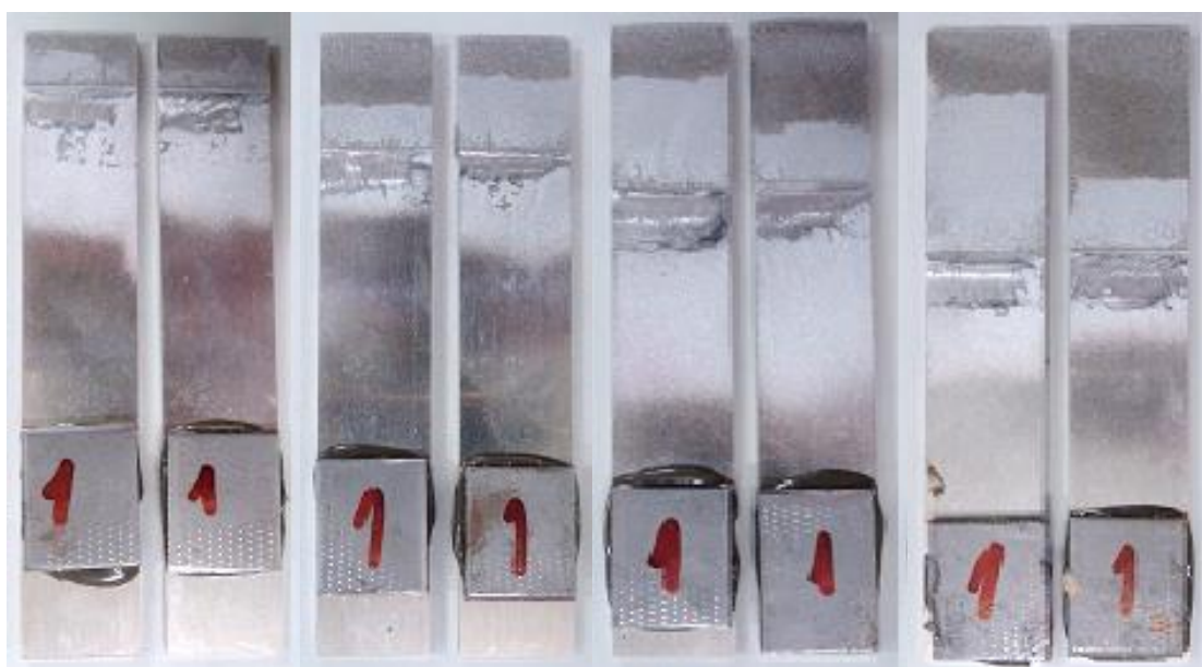
Figura 23 – Superfícies de rotura de provetes representativos de cada valor de L de juntas coladas com o adesivo Araldite ® AV138
