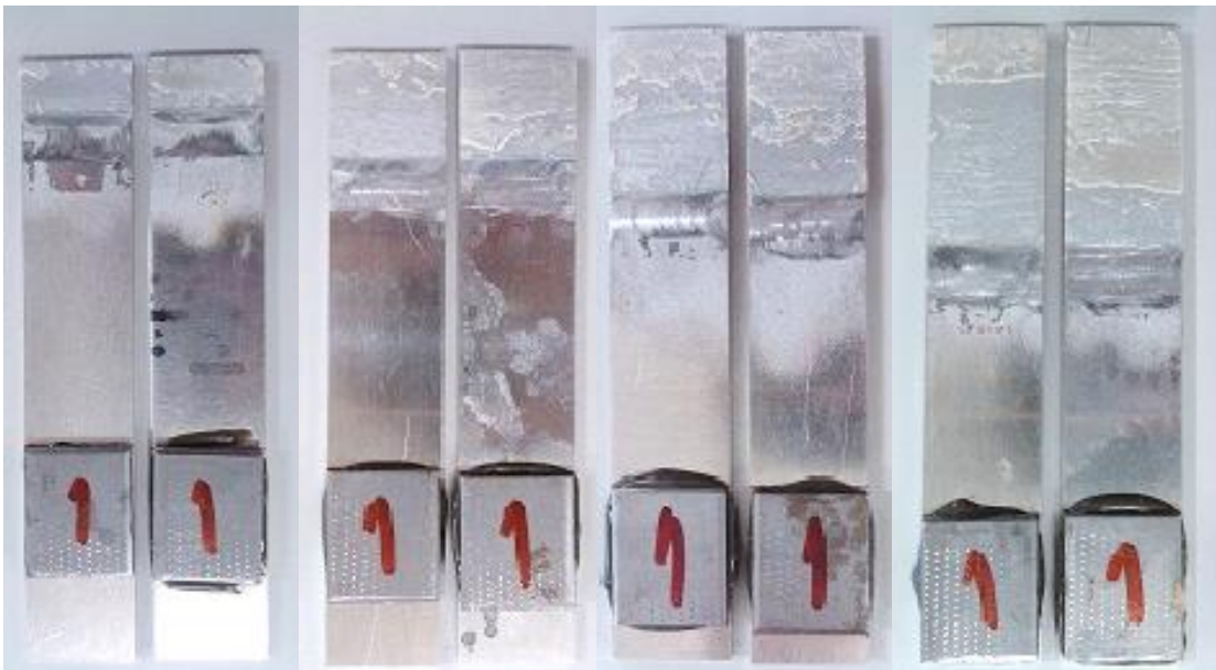
Figura 25 – Superfícies de rotura de provetes representativos de cada valor de L de juntas coladas com o adesivo Araldite® 2015
