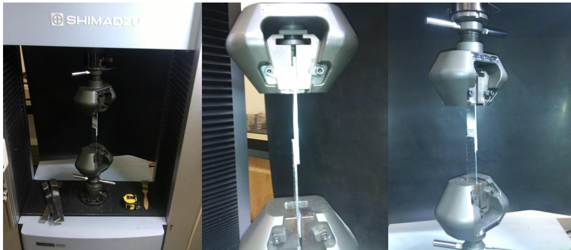
Figura 22 – Máquina de ensaio Shimadzu, modelo AG-X 100, e respectiva fixação dos provetes
