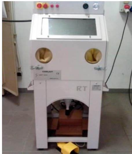
Figura 18 – Máquina de granalhagem “Cidblast” modelo RT6S [84]
