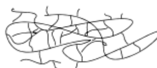
Figura 2.4 – Representação da estrutura macromolecular de um termoendurecível.
