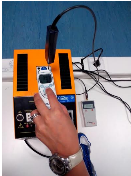
Figura 3.13.: Registrar a Temperatura indicada no indicador do Termómetro Timpânico
