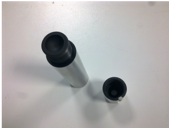
Figura 3.8.: Vista superior do Corpo negro, abertura da peça
