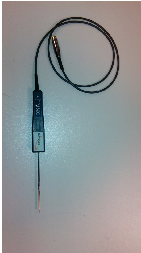
Figura 3.4.: Sensor Padrão Tipo Pt1000
