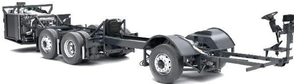
**Figura 7 – *Chassi* de veículo pesado de passageiros (M3)**
