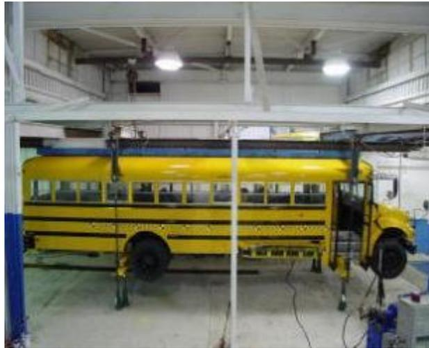
Figura 24 - Ensaio segundo a norma *FMVSS 220 (NHTSA, 1991)*
