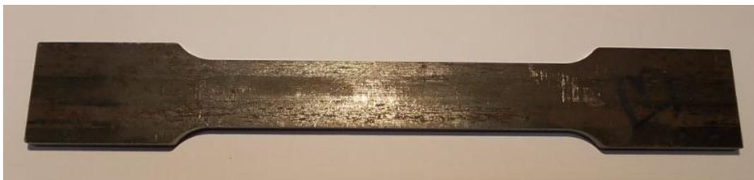
Figura 127 – Provete utilizado no ensaio de tracção
