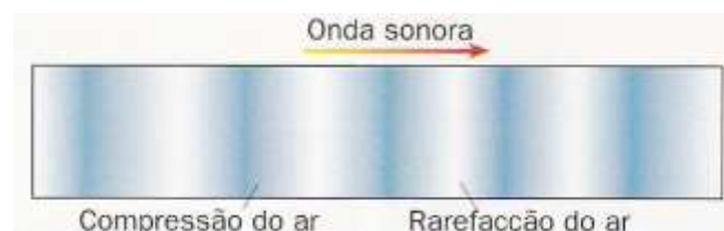
Figura 3.1 - Movimento das moléculas de uma onda sonora
