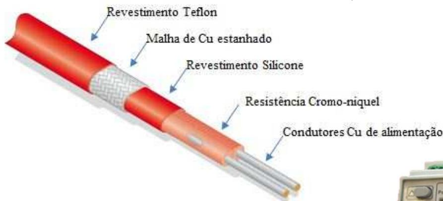
Figura 4. Cabo de traçagem de potência constante
