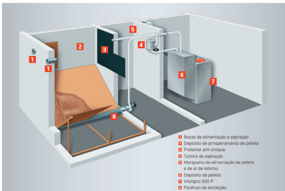
Figura 27 - Sistema de alimentação pneumático [77]
