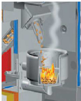
Figura 17 - Esquema de um leito fixo com alimentação superior [48]
