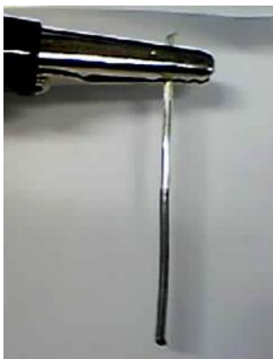
Figura:2.5 - Fio de Ag recoberto com AgCl (referência Ag/AgCl).
