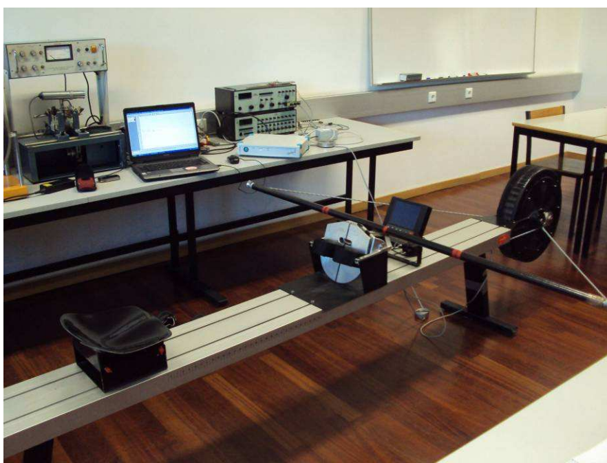
Figura 43 – Célula de carga montada no caiaque ergómetro.
