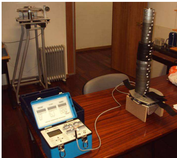
Figura 37 – Verificação da sensibilidade com uma força de aproximadamente 220N.
