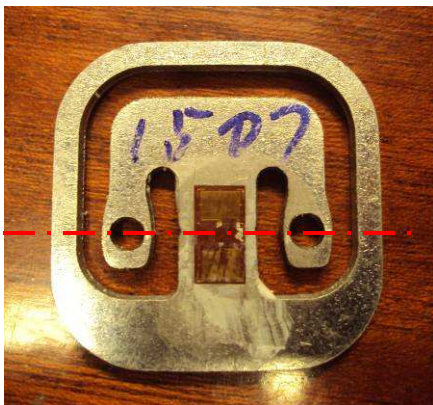
Figura 28 – Linha de eixo criada na célula de carga unitária e desenho 3D.
