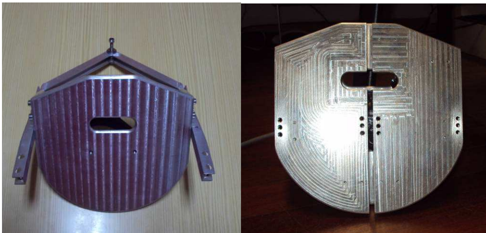
Figura 24 – Concepção do finca-pés em alumínio e as células de carga esquerda e direita.
