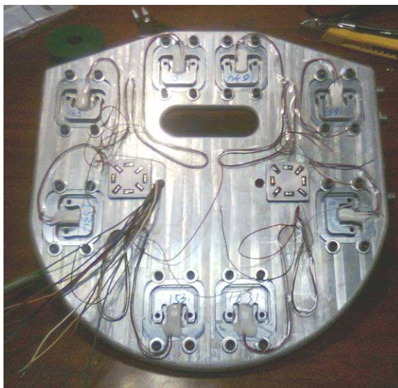
Figura 32 – Pormenor do posicionamento das células de carga unitárias.
