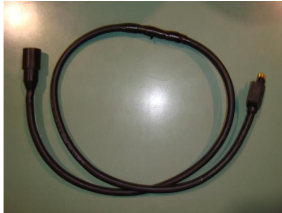
Figura B.3: Cabo de conexão entre o ROV VideoRay PRO 3E e o módulo INS&Lasers.
