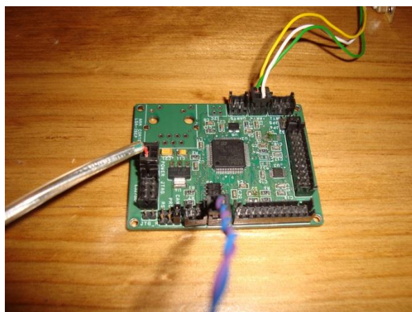
Figura B.5: Placa de desenvolvimento do ARM M3-Cortex STM32, disponibilizada pelo LSA.
