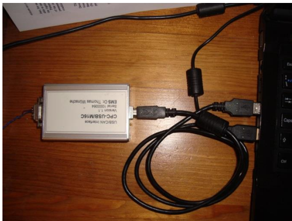
Figura B.4: Conversor USB/CAN utilizado para comunicar com o módulo INS&Lasers (modelo CPC-USB/M16C da EMS Dr. Thomas Wunsche).
