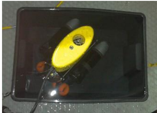
Figura 3.3: Setup experimental para medição do volume de fluido deslocado pelo ROV VideoRay PRO 3E.
