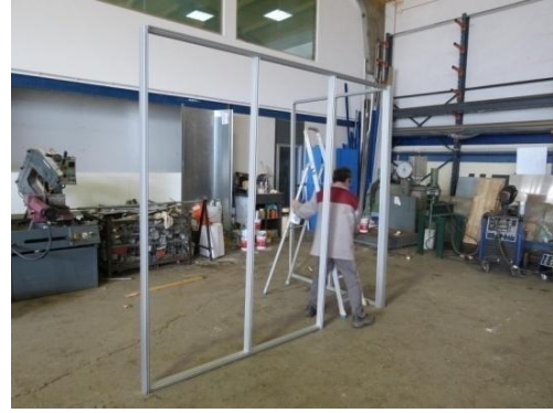
Figura 4.75: Montagem das caixilharias em fabrica
