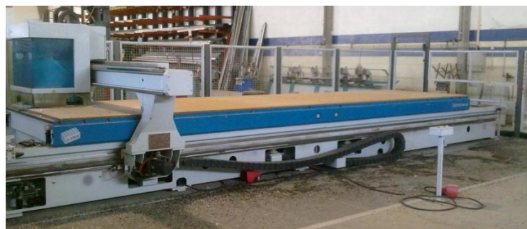
Figura 3.62: Mesa de corte dos painéis de Alucobond (CNC)
