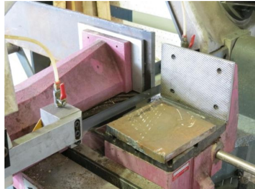
Figura 4.33: Máquina de corte de serra - corte de chapa de topo dos pilares HEB160
