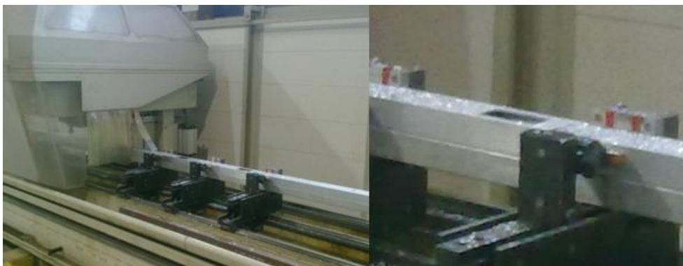
Figura 3.74: Abertura da cavidade na subestrutura
