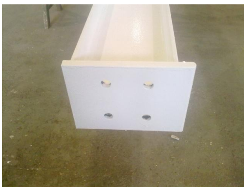
Figura 4.43: Tratamento superficial da estrutura metálica - Viga IPE200
