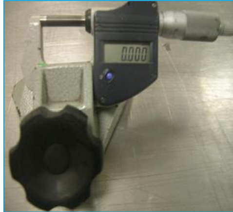
Figura 2.8 - Micrómetro utilizado para medição da espessura dos filmes extrudidos.
