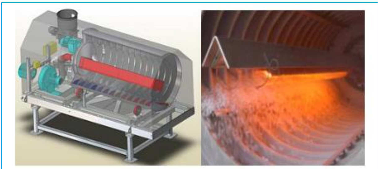
Figura 1.12 - Tambor rotativo e aquecimento por lâmpadas de infravermelhos.
