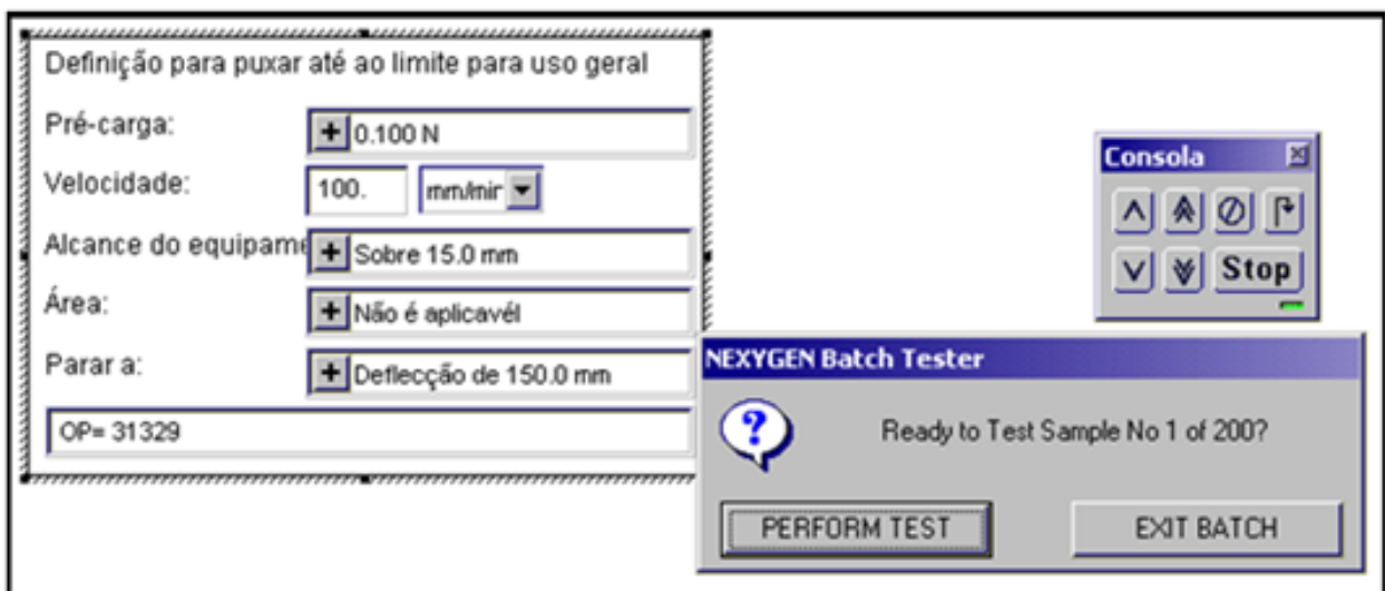
Figura 2.6 - Apresentação do dinamómetro para a realização do teste de Força Peel .
