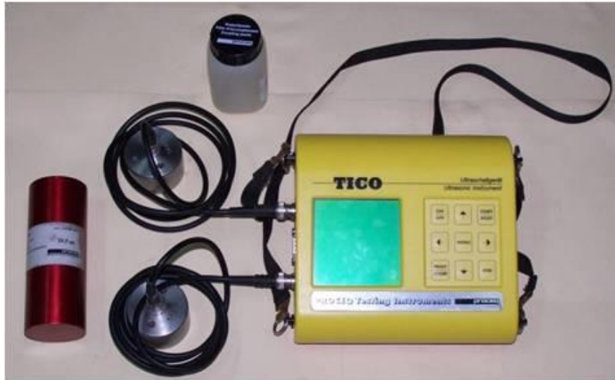
Figura 56 - Equipamento para o ensaio de ultra sons, TICO ( www.ampri.res.in ).
