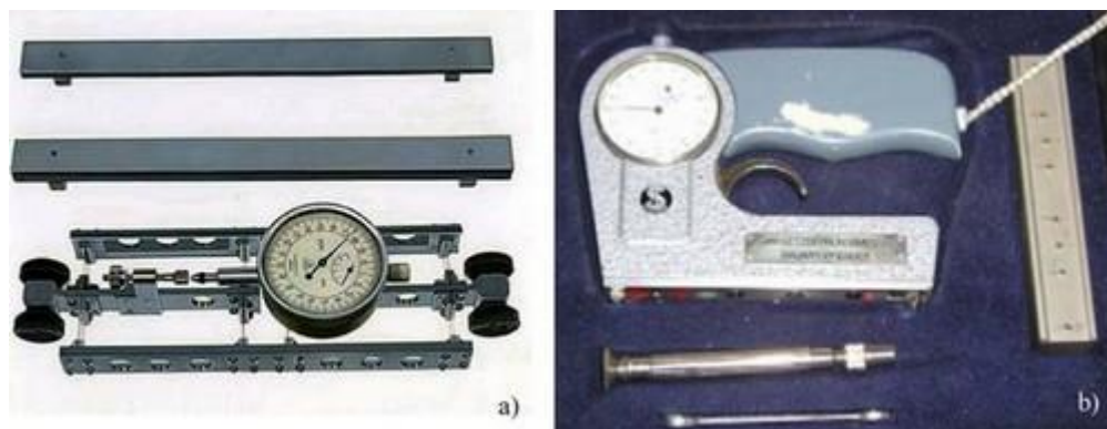
Figura 18 - a) Alongâmetro tipo LNEC; b) Alongâmetro de Staeger ( reabilitacaodeedificios.dashofer.pt ).
