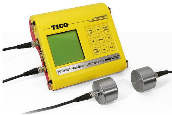
Figura 8 – Equipamento de ultra sons ( www.epc.com.hk ).
