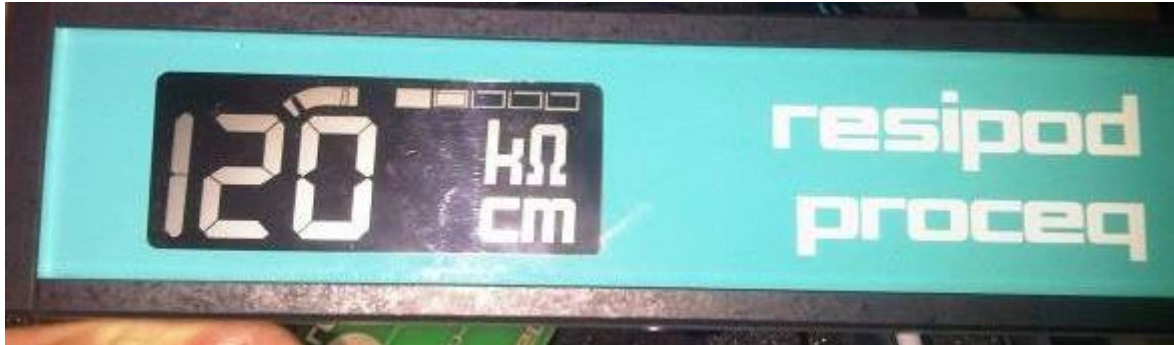
Figura 57 - Equipamento para o ensaio de resistividade do betão, RESIPOD.
