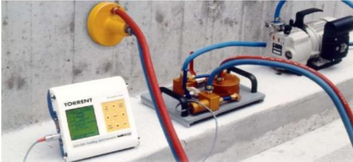
Figura 13 - Determinação da permeabilidade do betão ao ar e à água ( www.directindustry.com ).
