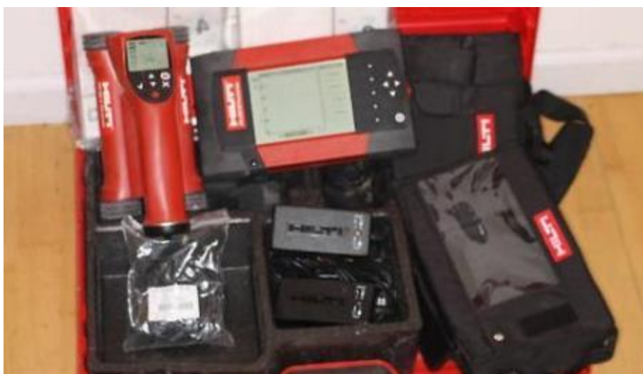
Figura 47 - Equipamento de deteção de armaduras, Ferroscan PS 200.
