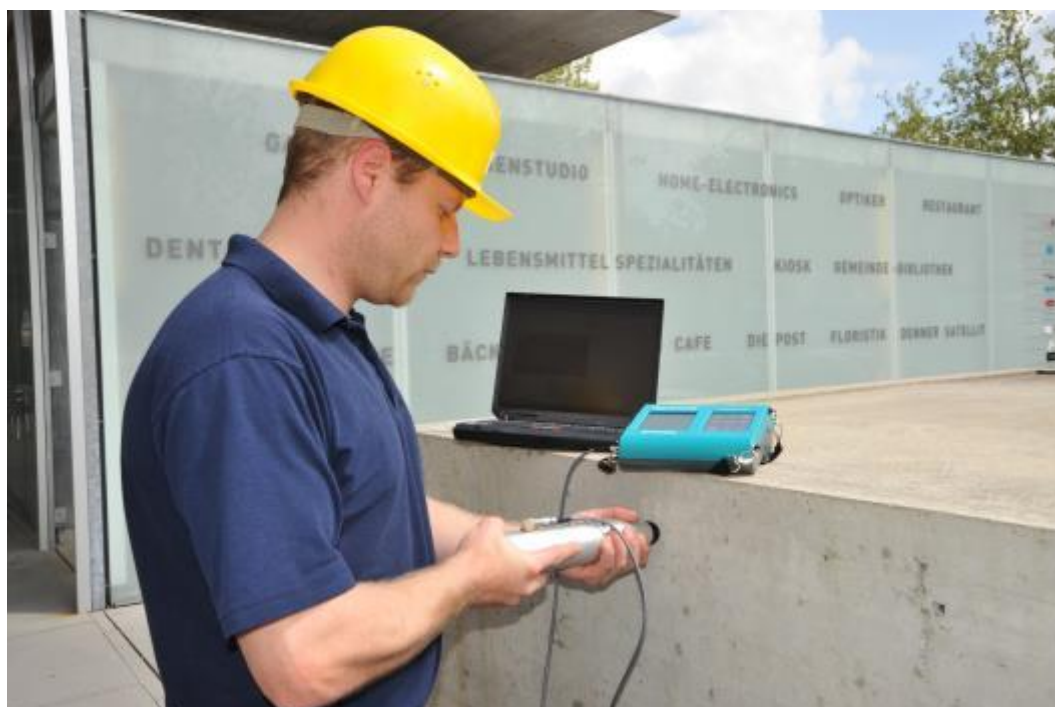
Figura 54 - Ensaio esclerométrico do betão, DIGI – SCHIMDT 2000 ( www.proceq.com ).
