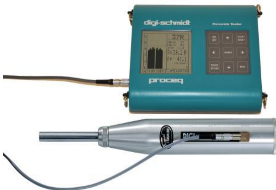
Figura 52 – Equipamento para o ensaio esclerométrico, DIGI-SCHMIDT 2000 ( www.proceq.com ).
