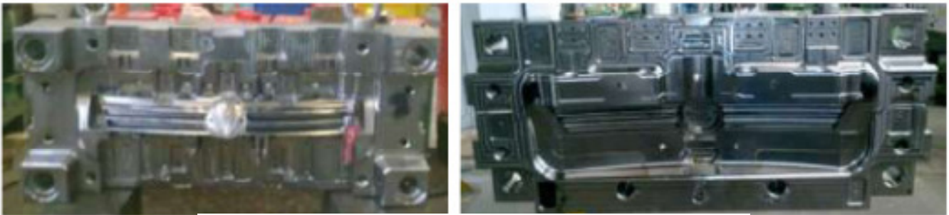
Figura 20 – Macho (esquerda) e Cavidade (direita).
