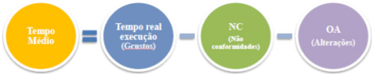
Figura 71 – Cálculo dos tempos médios de execução dos moldes.
