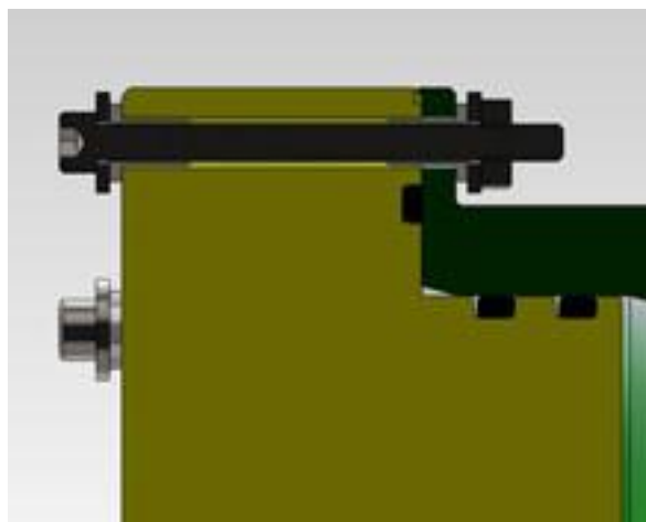
Figura 54 Ilustração do tipo de vedação por tampa com 3 o-rings
