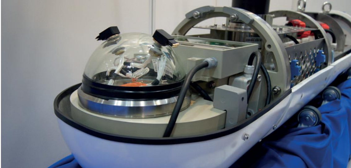
Figura 22 Esfera de instrumentação num AUV
