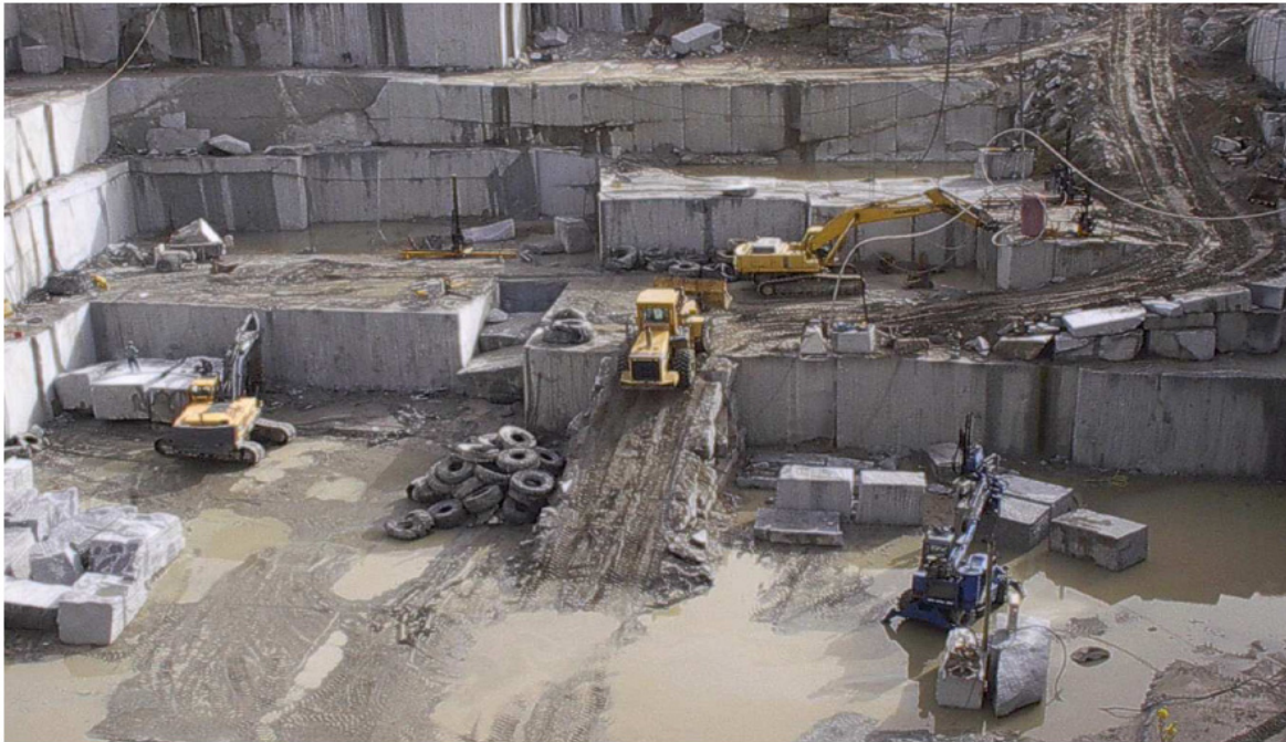
Figura 25 - Operações fundamentais de desmonte de rocha ornamental (granito) (Adaptado de Gomes et al., 2008).
