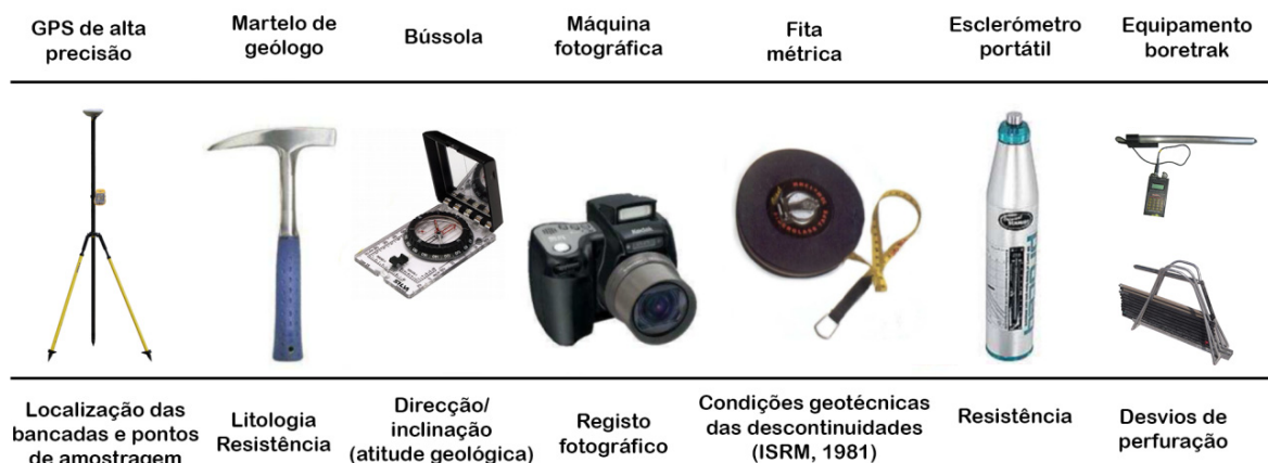
Figura 17 - Equipamento de campo básico para a utilização da técnica de amostragem linear aplicada a estudos geotécnicos e geomecânicos (González de Vallejo & Ferrer, 2011). In: Galiza (2013).
