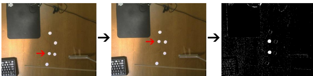
Figura 85 – Resultado do algoritmo background subtraction MOG2
