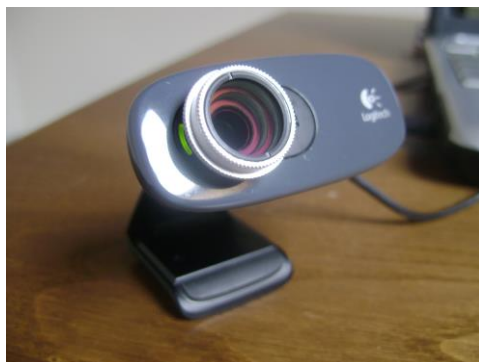
Figura 108 – Lente polarizada aplica na câmera utilizada na proposta do DSA
