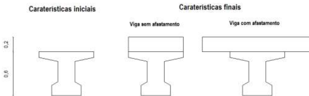
Figura 5.12 – Características em fase construtiva
