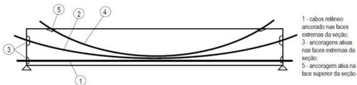
Figura 5.20 – Posicionamento das ancoragens em vigas simplesmente apoiadas. [Pfeil 1894]
