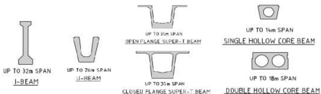
Figura 2.1 – Vigas standard da Nova Zelândia [8]
