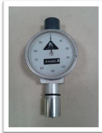
Figura 34: Durómetro de mão “Shore A”
