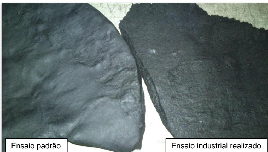
**Figura 86: Comparação do ensaio padrão C121.02 com o ensaio industrial C121.02 realizado com resíduo de pó de pneus**
