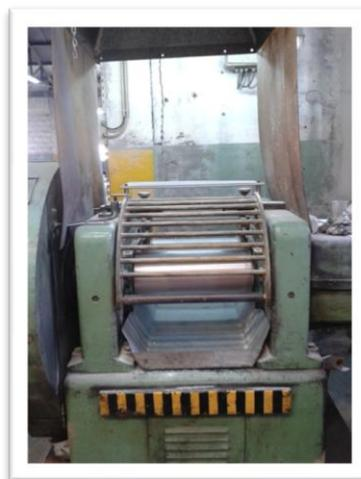
Figura 43: Misturador aberto laboratorial
