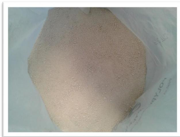
**Figura 101: Granulado de Airlite**
