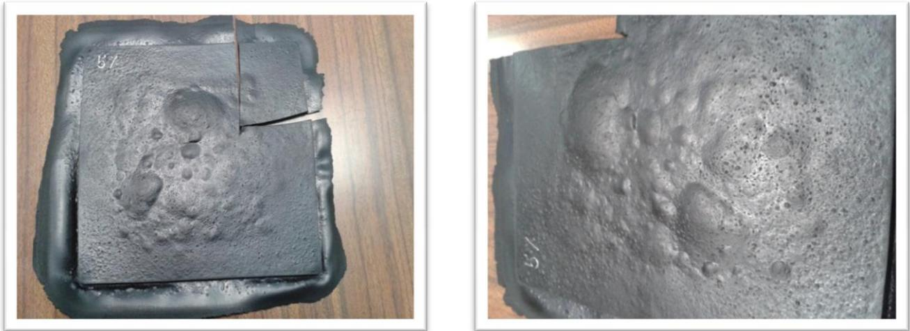
**Figura 46: Placa A<sub>1,2</sub> após vulcanização**
