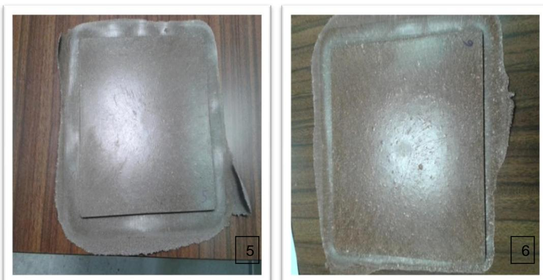
Figura 105: Placas 5 e 6 após vulcanização
