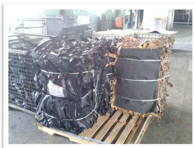
**Figura 19: Rebarbas provenientes das placas vulcanizadas**
