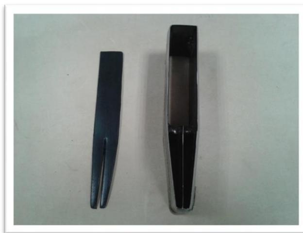
Figura 36: Cortante e provete para rasgamento
