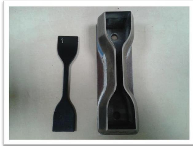
Figura 30: Amostra para a tensão de rutura e alongamento
